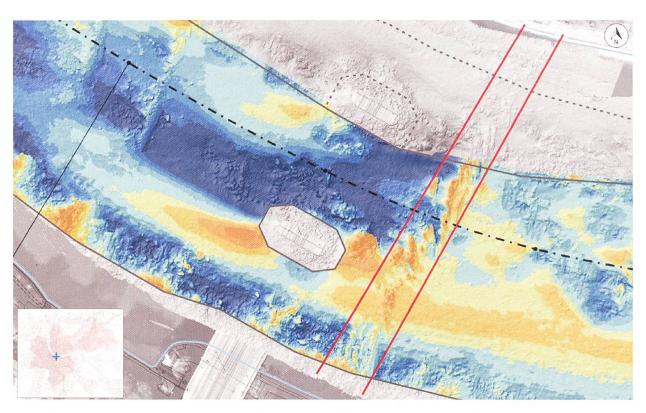
Abb. 4 Ausschnitt der Fächerecholotaufnahmen der Rheinsohle im Abschnitt Wettsteinbrücke vor der Baumassnahme. Die rote Umrandung zeigt eine der Felsrippen im Abschnitt.
