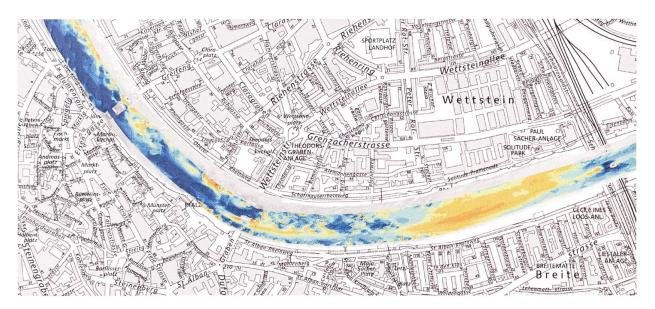
Abb. 2 Ausschnitt der Sohlevermessung der Rheinsohle. Die Flächen in Blautönen sind bereits tief genug. In den gelben und orangen Bereichen mussten Massnahmen ausgeführt werden. Quelle: TBA BS
