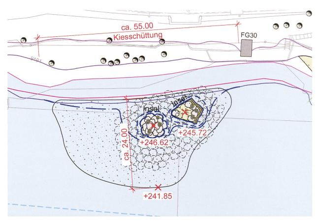
Abb. 7 Planausschnitt (nicht massstabsgetreu) einer der geplanten Inseln mit dem Steinverbau (schwarz umrandete Kreise) und der Kiesfläche (gepunktete Fläche).
