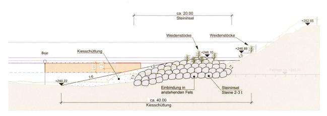
Abb. 8 Querprofil im Abschnitt Schaffhauserrheinweg. Die Buhnen sind in den Fels eingebunden, mit Kies eingeschüttet und mit Weiden bestockt.
