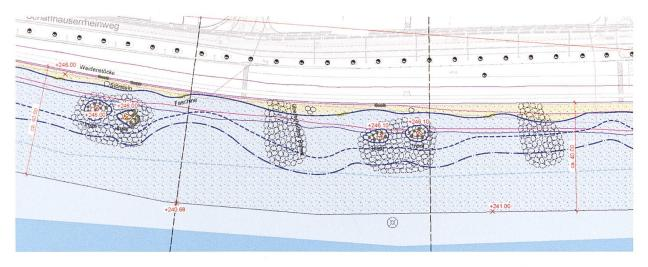
Abb. 6 Planausschnitt (nicht massstabsgetreu) eines der geplanten Flachwasserbereiche mit Buhnen und Inseln (schwarz umrandete Kreise) und Schüttungsfläche (gepunktete Fläche). Quelle: HOLINGER AG
