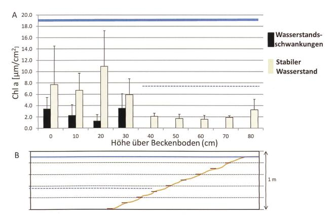
Abb. 3 A) Einfluss von Wasserstandsschwankungen auf die Primärproduktion in zwei Versuchsbecken der Universität Konstanz. Die blaue fette und gestrichelte Linie zeigt jeweils den maximalen und minimalen Wasserstand im Versuch an. B) Schemazeichnung des Versuchsbeckens im Längsschnitt mit der künstlichen Uferzone (gelb), den Kacheln (braun) als Flächen für den Algenbewuchs, die Messstufen der unter A gezeigten Höhenstufen sind durch gestrichelte graue Linien dargestellt.
