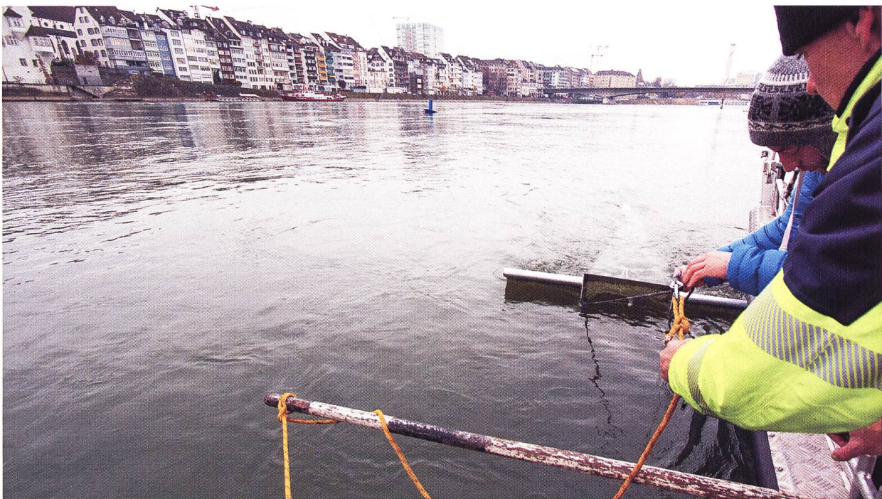
Abb. 1 Manta-Trawl zum Sammeln von Mikroplastikpartikel im Rhein bei Basel.
