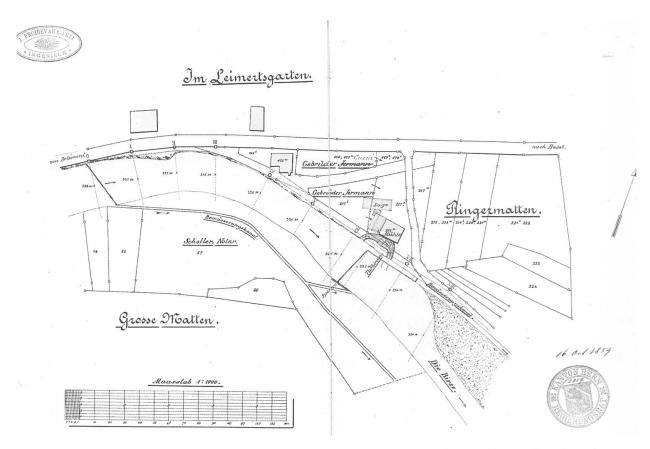
Abb. 3 Wasserentnahme für einen Bewässerungskanal und eine Sägerei in Zwingen. Situationsplan von 1859. Quelle: Archiv Amt für Umweltschutz und Energie 2019
