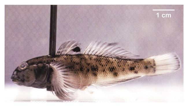
Abb. 3 In einem Laborversuch der Universität Basel werden bereits tote Schwarzmundgrundeln an einem Stab im Strömungskanal fixiert. So werden die Kräfte bestimmt, die der Fisch bei der Passage eines Fischpasses überwinden muss. So soll ein Mittel gefunden werden, um den Aufstieg der Fische zu regulieren.
