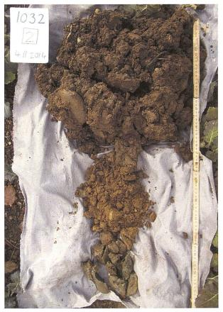
Abb. 3 Links: Spatenprofil einer gut gelungenen Rekultivierung (gutes Bodenmaterial, pflanzennutzbare Gründigkeit [PNG] = 73 cm). Rechts: Beispiel eines mangelhaft rekultivierten Bodens (Material ab 50 cm Tiefe mit Aushub vermischt, Anzeichen von Staunässe, PNG = 35 cm). Fotos: Soilcom GmbH
