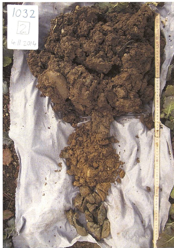
Abb. 3 Links: Spatenprofil einer gut gelungenen Rekultivierung (gutes Bodenmaterial, pflanzennutzbare Gründigkeit [PNG] = 73 cm). Rechts: Beispiel eines mangelhaft rekultivierten Bodens (Material ab 50 cm Tiefe mit Aushub vermischt, Anzeichen von Staunässe, PNG = 35 cm).
