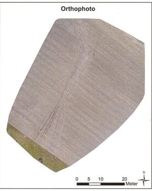
Abb. 4 Erosionsrillen in Gelterkinden "Lachmatt": Das Bild links zeigt das Höhenmodell, dasjenige rechts ein Orthophoto. Das Höhenmodell und das Orthophoto wurden mit Drohnenbildern aus demselben Drohnenflug generiert. Die Flughöhe betrug 10 m, die Geschwindigkeit der Drohne wurde auf ein Minimum reduziert, und es wurden Aufnahmen aus verschiedenen Flugrichtungen gemacht (Double Grid) (eigene Darstellung *Delia Mändli* 2017).
