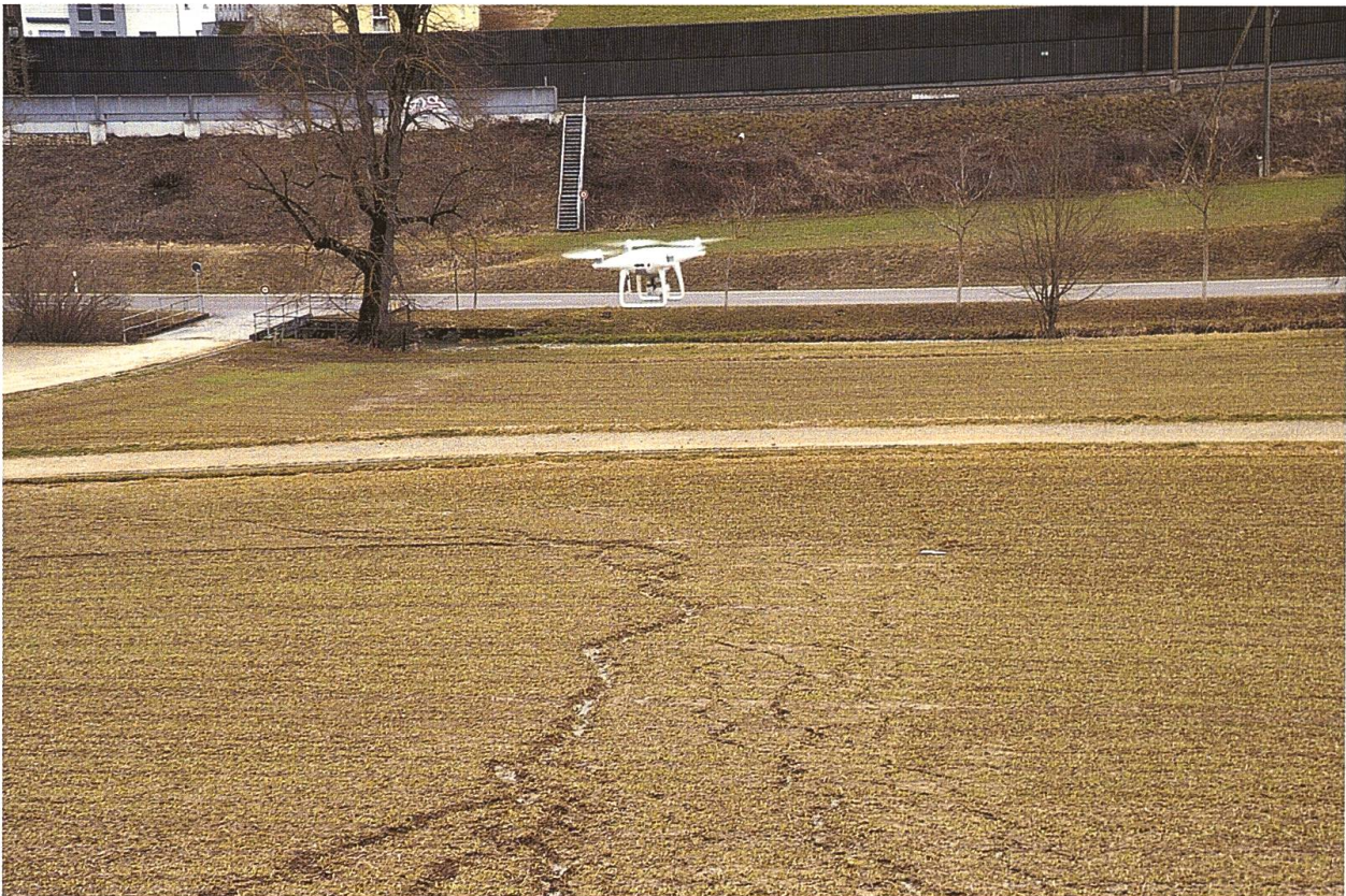
Abb. 3 Drohnenflug über Bodenerosionsrillen.
