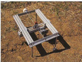
Abb. 2 Volumenabschätzung des Bodenabtrags mittels einer Drohne (links) und Lasermessung als Validierungsmethode (rechts). Fotos: D. Mändli 2017
