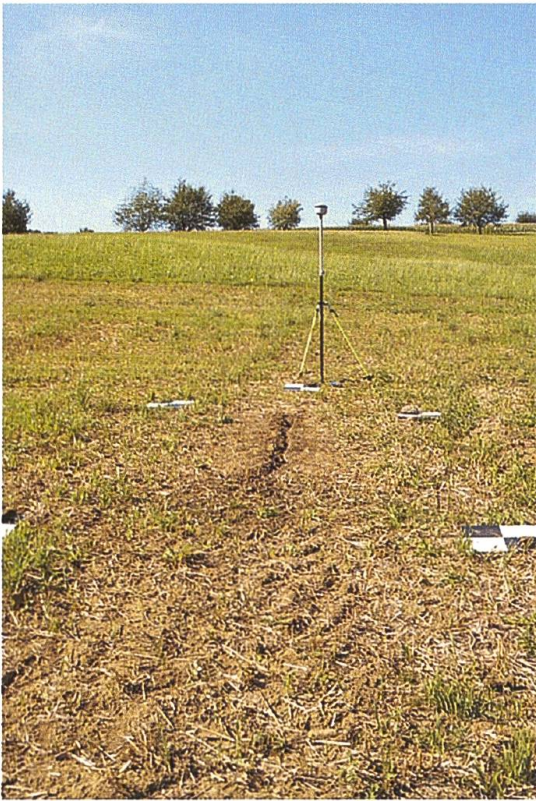
Abb. 2 Volumenabschätzung des Bodenabtrags mittels einer Drohne (links) und Lasermessung als Validierungsmethode (rechts). Fotos: D. Mändli 2017
