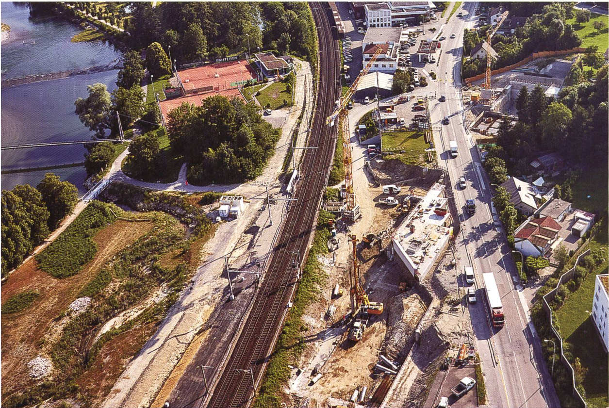
Abb. 2 Tunnelportal (oben rechts) und Portal des Tagbautunnels (Mitte rechts), des Eppenbergtunnels in Gretzenbach (SO), dem Kernstück des Vierspurausbaus der SBB zwischen Olten und Aarau. Linkerhand der Bachlauf des frisch renaturierten Gretzenbachs. Foto: Drohnenbild der SBB, 22.03.2017
