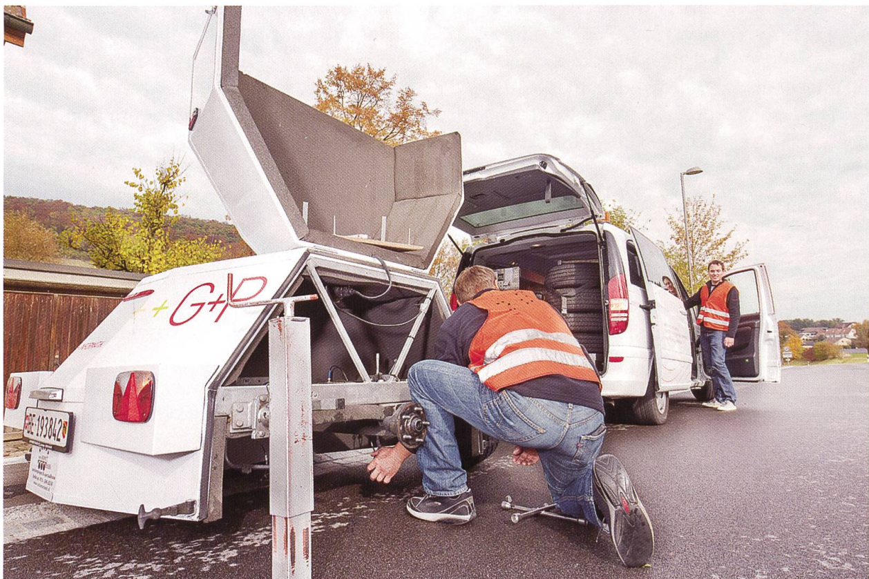
Abb. 2a (oben) und 2b (unten) CPX Anhängermethode von Grolimund + Partner AG während der Einrichtung des Messsystems. a) Der Messtechniker richtet die beiden Mikrofone bei geöffnetem Anhängerflügel aus und kalibriert diese zugleich. b) Der Messingenieur überprüft das Kalibrationssignal am Messlaptop, welcher sich auf einem Tisch auf dem Beifahrersitz befindet.
