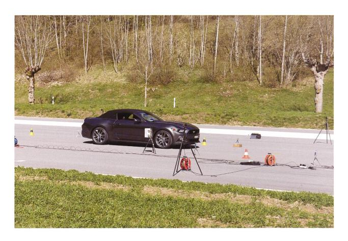
Abb. 6a (oben) und Abb. 6b (unten) Akkustische Vorbeirollmessungen mit abgeschaltetem Motor (Coast-by) eines breiten Reifens an einem Ford Mustang (Abb. 6a) und das CPX-Messfahrzeug mit allen im Forschungsprojekt analysierten Reifen (Abb. 6b). Die sogenannten Coast-by-Messungen dienten zur Abschätzung der Unsicherheiten bei den Messungen der Reifen an einem für die Reifen üblichen Fahrzeug (Abb. 6a) im Vergleich zu den Messungen, bei denen die Reifen am CPX-Anhänger (Abb. 6b) montiert sind.
