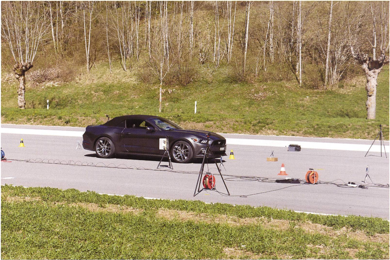
Abb. 6a (oben) und Abb. 6b (unten) Akkustische Vorbeirollmessungen mit abgeschaltetem Motor (Coast-by) eines breiten Reifens an einem Ford Mustang (Abb. 6a) und das CPX-Messfahrzeug mit allen im Forschungsprojekt analysierten Reifen (Abb. 6b). Die sogenannten Coast-by-Messungen dienen zur Abschätzung der Unsicherheiten bei den Messungen der Reifen an einem für die Reifen üblichen Fahrzeug (Abb. 6a) im Vergleich zu den Messungen, bei denen die Reifen am CPX-Anhänger (Abb. 6b) montiert sind.
