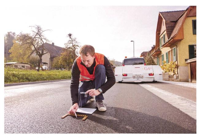
Abb. 5 Detaillierte Dokumentierung eines Analysequerschnitts von einem lärmarmen Belag. Bei jeder Messung wird der Strassenbelag optisch begutachtet, indem auf die Zugänglichkeit der Porenstruktur geschaut wird und allfällige Verschmutzungen während der Messung oder Kornausbrüche dokumentiert werden.
