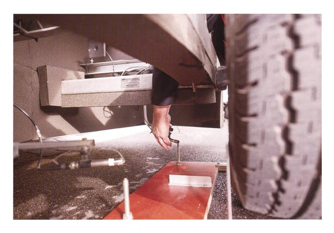
Abb. 2a (oben) und 2b (unten) CPX Anhängermethode von Grolimund + Partner AG während der Einrichtung des Messsystems. a) Der Messtechniker richtet die beiden Mikrofone bei geöffnetem Anhängerflügel aus und kalibriert diese zugleich. b) Der Messingenieur überprüft das Kalibrationssignal am Messlaptop, welcher sich auf einem Tisch auf dem Beifahrersitz befindet.
