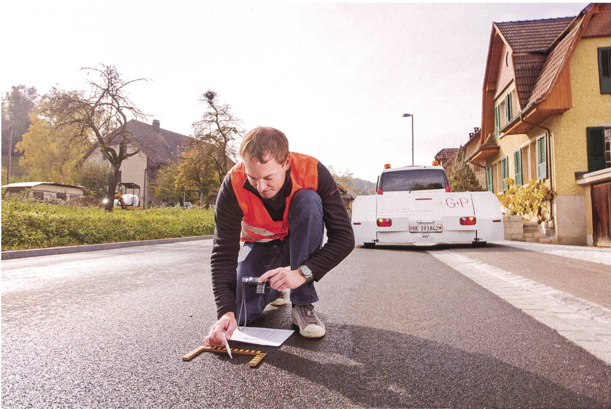
Abb. 5 Detaillierte Dokumentierung eines Analysequerschnitts von einem lärmarmen Belag. Bei jeder Messung wird der Strassenbelag optisch begutachtet, indem auf die Zugänglichkeit der Porenstruktur geschaut wird und allfällige Verschmutzungen während der Messung oder Kornausbrüche dokumentiert werden.
