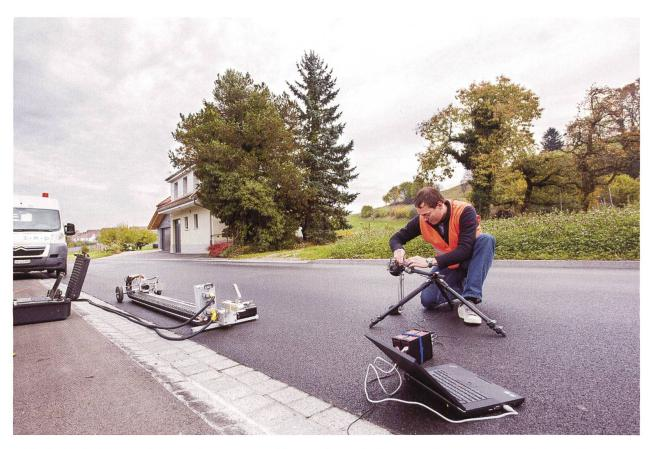
Abb. 4 Schallabsorptions-Luftströmungswiderstand- sowie Lasertexturmessungen auf einem lärmarmen Belag. Links im Bild befindet sich der 2 Meter lange Balken, an welchem der Laser befestigt ist, um die Oberflächentextur zu messen. Rechts montiere ich den Lautsprecher, welcher mit dem untenstehenden Mikrofon die Schallabsorption des Strassenbelages misst.
