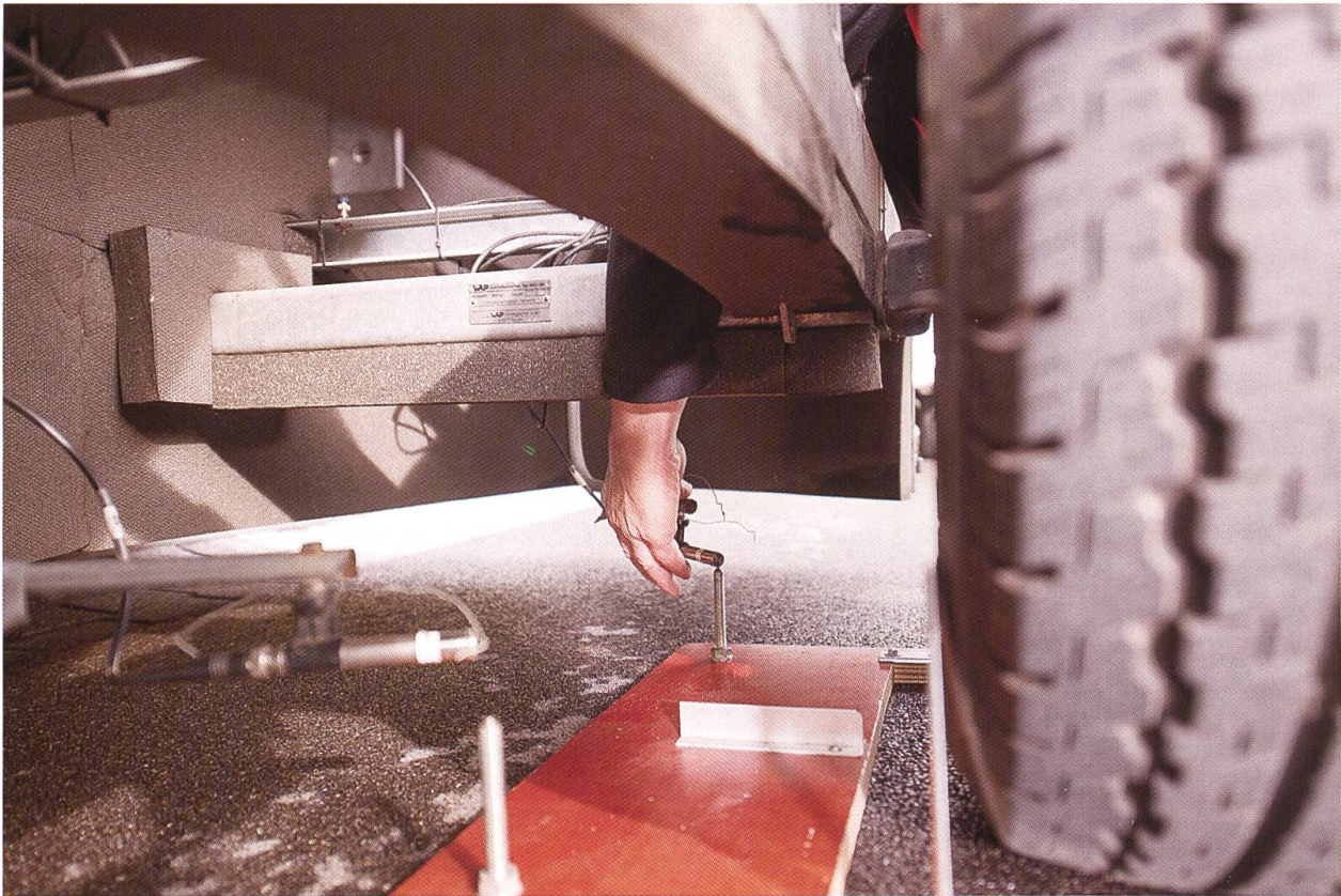
Abb. 2a (oben) und 2b (unten) CPX Anhängermethode von Grolimund + Partner AG während der Einrichtung des Messsystems. a) Der Messtechniker richtet die beiden Mikrofone bei geöffnetem Anhängerflügel aus und kalibriert diese zugleich. b) Der Messingenieur überprüft das Kalibrationssignal am Messlaptop, welcher sich auf einem Tisch auf dem Beifahrersitz befindet.
