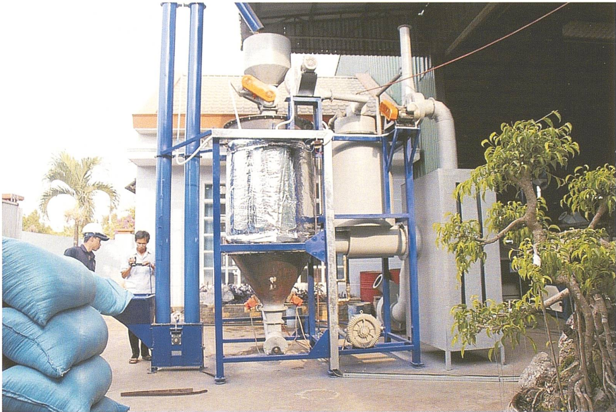
Abb. 3 Die PPP120-Anlage – das in Vietnam nachgebaute Gerät des Ökozentrums. Aus feuchter Kaffeepulpe wird Kohle und Kaliumdünger erzeugt und gleichzeitig 150 kW Heizleistung für den Trockner mit einem Inhalt von 4 t Rohkaffee geliefert. Noch grössere Anlagen sind ebenfalls denkbar und in Planung.
