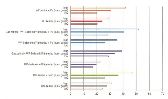
Abb. 4 Gestehungskosten für Warmwasser in Rp. pro kWh gezapftem Warmwasser (Einfamilienhaus, rund 200 m², Gebäudehülle saniert gemäss *EnDK* [2008], Energiebedarf für Raumwärme und Warmwasser rund 75 kWh/m², Anteil Energiebedarf für Warmwasser rund 20 %).
