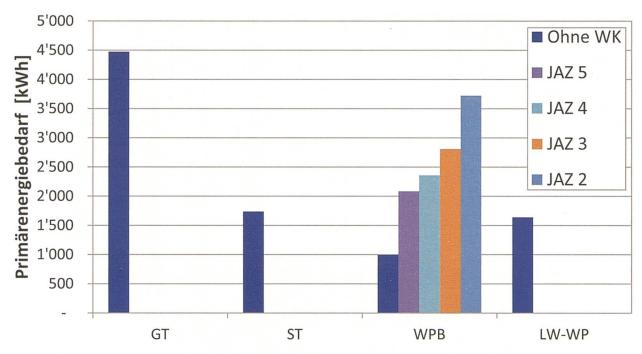
Abb. 3 Nicht erneuerbarer Primärenergiebedarf der verschiedenen Basissysteme (siehe Abb. 1) in Abhängigkeit der Jahresarbeitszahl (JAZ) der Wärmepumpe für Raumwärme bei Wärmeklau (WK). Optimale Kollektorausrichtung bei Speichertemperatur 50 °C und Wetterdaten von 2013, Bilanzierungszeitraum 1 Tag.
