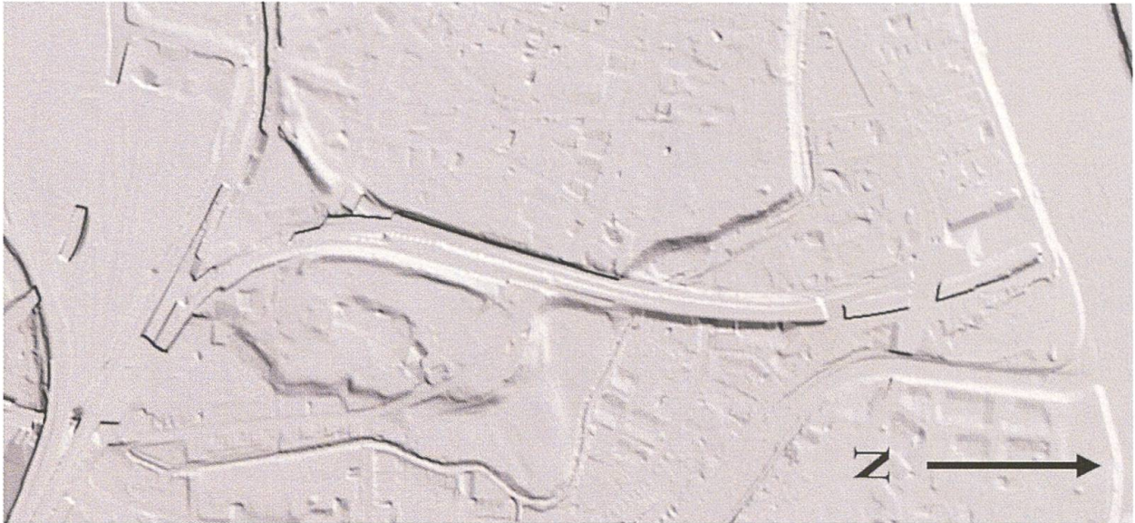
Abb. 9 Schummerungsbild des bebauten Reliefs zwischen dem Güterbahnhof Wolf in Basel (links) und dem Breite-Quartier sowie Rheinufer (rechts). Die Autobahn- wie auch die Eisenbahnlinien durchschneiden in nördlicher Richtung die Niederterrasse des Gellert-Quartiers, was beim Passieren dieser Strecke wahrnehmbar und im Bild durch die Farbgebung (weisses und schwarzes Band) dargestellt ist.
