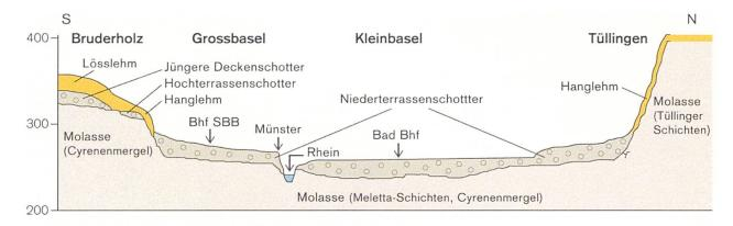
Abb. 7 Geologisches Querprofil zwischen dem Bruderholz und Tüllingen mit den tertiären Molasseschichten als Basis, dem darüber liegenden pleistozänen Schottermaterial des jüngeren Deckenschotters auf dem Bruderholz, den Hochterrassenschottern und den Niederterrassenschottern. Die Terrassentreppe im südlichen Basel ist mit der Abstufung von den jüngeren Deckenschottern über die Hochterrasse zur Niederterrasse dargestellt.
