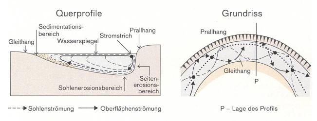
Abb. 4 Das Fliessverhalten und die Strömung des Rheins in Basel im Querprofil und Grundriss. Die Krümmung des Flusslaufs und damit verbunden das typische Verhalten der Sohlen- und Oberflächenströmungen bestimmen die Erosions- und Akkumulationsprozesse entlang des Mäanderbogens.
