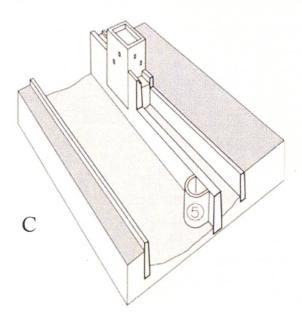
Abb. 6 Modell der baulichen Entwicklung der inneren Stadtbefestigung nach *Matt & Rentzel* (2004, verändert): A) Bau der Burkhardschen Stadtmauer (1), des Viereckturms (2) und des Grabens (7) Ende 11. Jh., B) Teilabbruch des Viereckturms und Bau der Inneren Stadtmauer (3) sowie der Kontermauer (6) und Hochziehen des Turms (4) in der 1. Hälfte des 13. Jh., C) Anbau halbrunder Schalentürme (5) an die Innere Stadtmauer um 1300.
