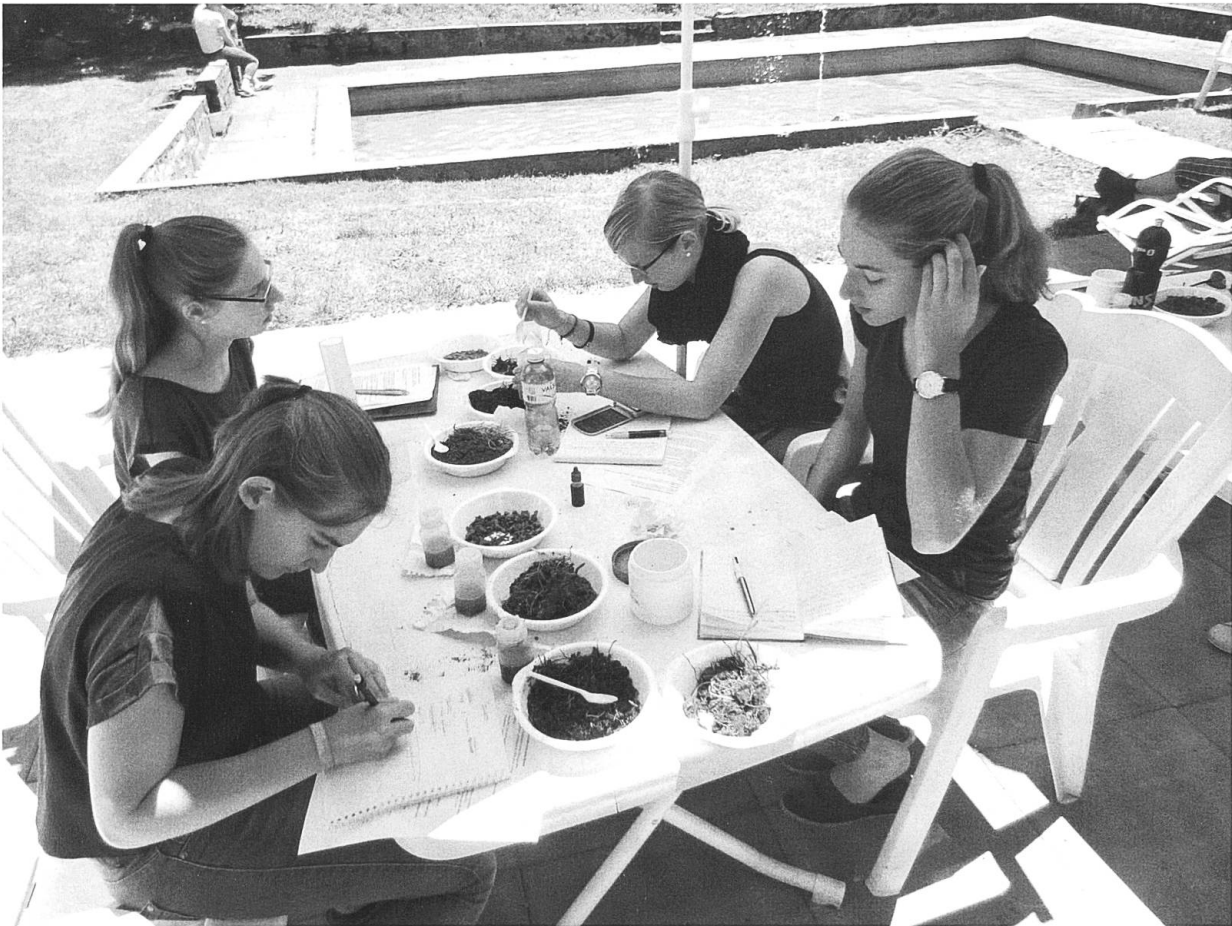
Abb. 5 Eine Gruppe von Schülerinnen bei der Untersuchung von Bodenproben. In den 100 ml-Fläschchen wurden Bodenextrakte hergestellt, um die Leitfähigkeit als Summenparameter für den Nährstoffgehalt zu bestimmen. Der Boden-pH-Wert wurde mittels Indikatorlösung direkt am Feinmaterial mittels Farb-Skala gemessen.
