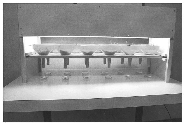
Abb. 6 Zwölffach-Berlese-Apparat (DaBa Scientific, D. Basler) zur Extraktion von Bodenarthropoden. Durch Licht und Wärme bewegen sich die Bodentiere (v. a. Springschwänze, Mückenlarven und Milben) nach unten und fallen durch den Trichter in die Fixierflüssigkeit. Anschliessend werden die Fänge unter dem Binokular (20-fach) untersucht und ausgewertet.
