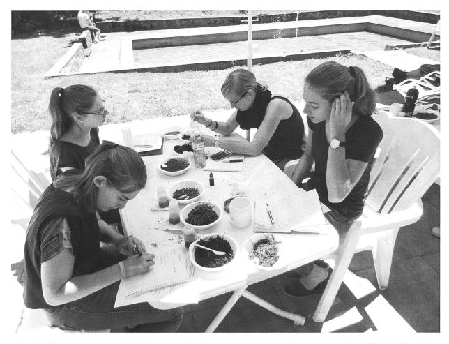
Abb. 5 Eine Gruppe von Schülerinnen bei der Untersuchung von Bodenproben. In den 100 ml-Fläschchen wurden Bodenextrakte hergestellt, um die Leitfähigkeit als Summenparameter für den Nährstoffgehalt zu bestimmen. Der Boden-pH-Wert wurde mittels Indikatorlösung direkt am Feinmaterial mittels Farb-Skala gemessen.
