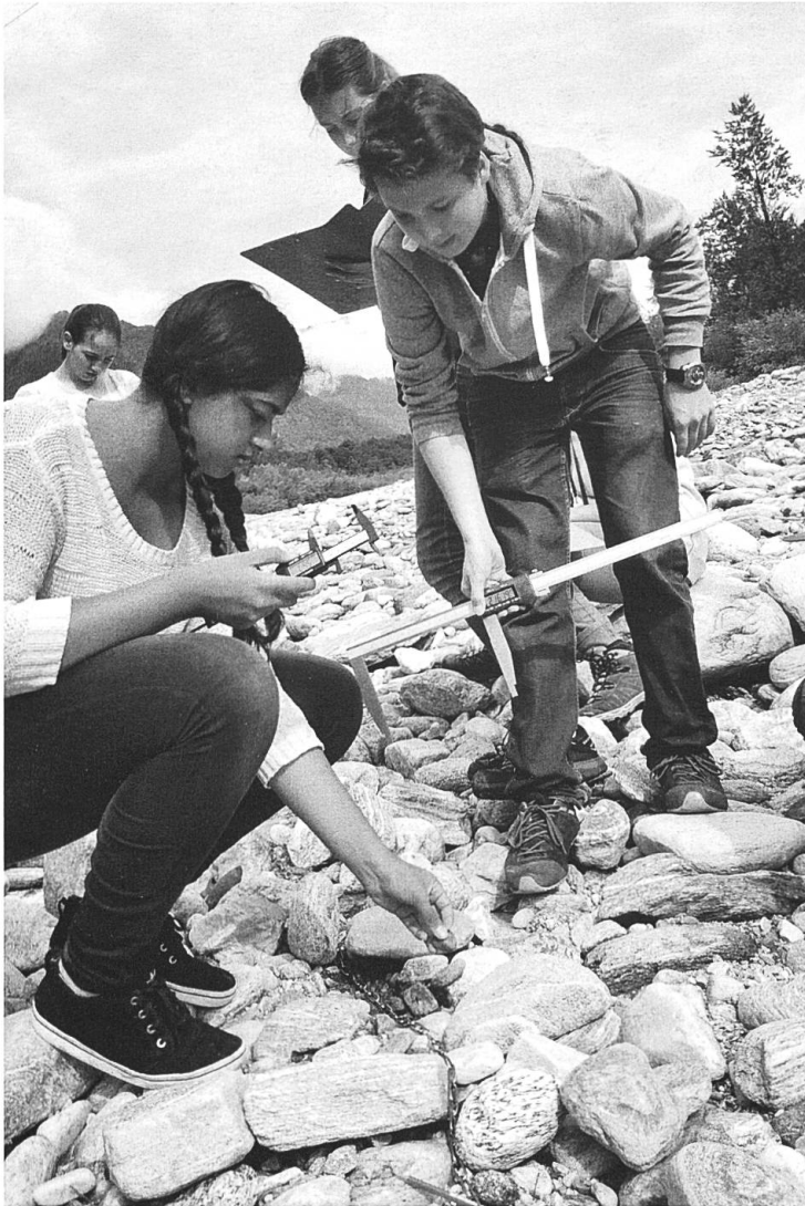
Abb. 5 Vermessung der Schotter und Kiese entlang einer 15 m langen Kette. Jeder von der Kette berührte Stein wurde gemessen. Das Total der vermessenen Gesteine pro Aufschluss lag bei 200–300 Messungen, der Arbeitsaufwand lag je nach Lokalität bei etwa 40 Minuten.
