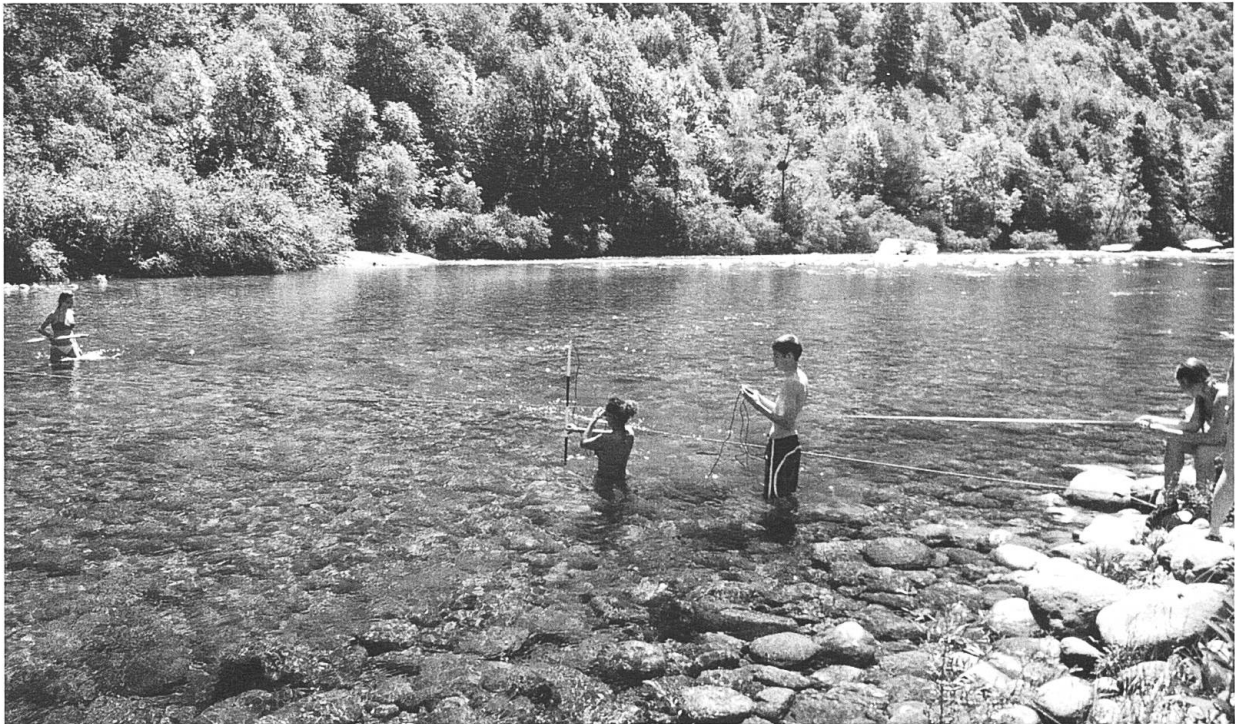
Abb. 4a Schülerinnen und Schüler bei der Vermessung des Profils bei Cevio (nicht überall war das Wasser derart ruhig). Von links: Malena mit der Messlatte zur Erfassung der Wassertiefen, Amanda misst die Strömungsgeschwindigkeit, Lars liest die Werte auf der digitalen Anzeige ab und Jana hält das Band zur Messung der Flussbreite.
