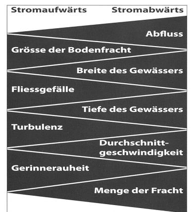
Abb. 3 Das sogenannte "Bradshaw Modell" (*Bradshaw* et al. 1978; eine Vereinfachung des Modells von *Schumm* 1977) zeigt, wie sich diverse Parameter entlang eines Flusslaufs verändern. Veränderungen der Trends können zum Beispiel durch Eingriffe des Menschen in den Flusshaushalt ausgelöst werden. Obwohl das Modell stark vereinfachend ist, bietet es den Schülern Raum, um eigene Arbeitshypothesen zu formulieren, indem sie die Aussagen des Modells mit der gemessenen Wirklichkeit vergleichen.
