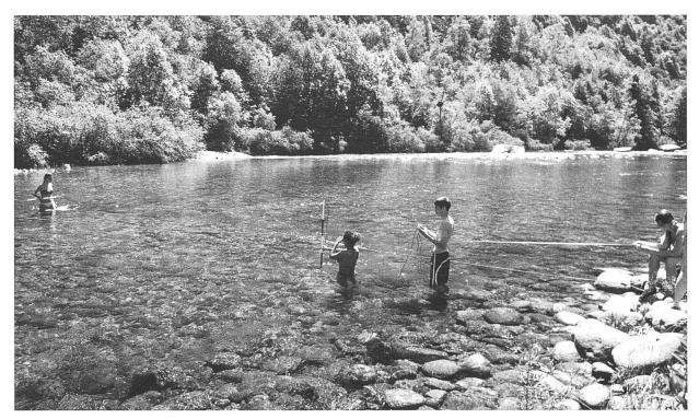
Abb. 4a Schülerinnen und Schüler bei der Vermessung des Profils bei Cevio (nicht überall war das Wasser derart ruhig). Von links: Malena mit der Messlatte zur Erfassung der Wassertiefen, Amanda misst die Strömungsgeschwindigkeit, Lars liest die Werte auf der digitalen Anzeige ab und Jana hält das Band zur Messung der Flussbreite.
