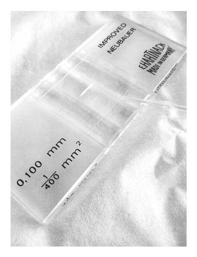
Abb. 2 Auf dem Foto ist eine Neubauer Zählplatte zu sehen. Mittig liegt ein Gitternetz, mit dessen Hilfe unter dem Mikroskop die Planktonzellen gezählt wurden. Die Aufnahme zeigt auch, wie mittels einer Pipette eine Probe aus einem Versuchskolben in die Zählkammer gegeben wird. Foto: Hugo Braun
