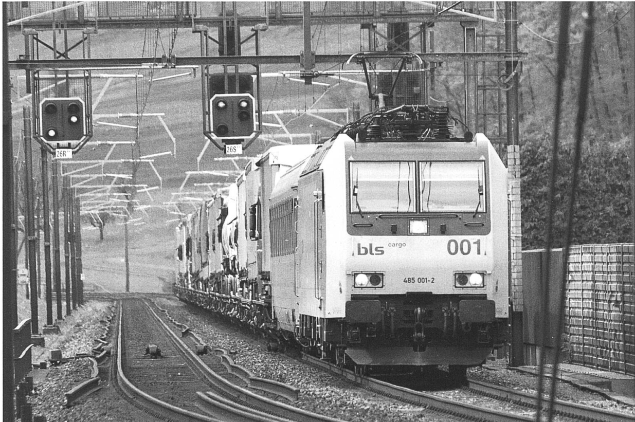
Abb. 4 Das Sonderprofil der Huckepackzüge (4 m Eckhöhe der Lastwagen) gegenüber dem üblichen Lichtraumprofil der Lokomotive und des Begleitwagens ist aus dieser Perspektive deutlich erkennbar. Der Zug ist auf der nördlichen, doppelspurig SIM-tauglichen Zulaufstrecke des LBT zwischen Basel und Olten bei Tecknau unterwegs (30. April 2012). Foto: O. Stucki
