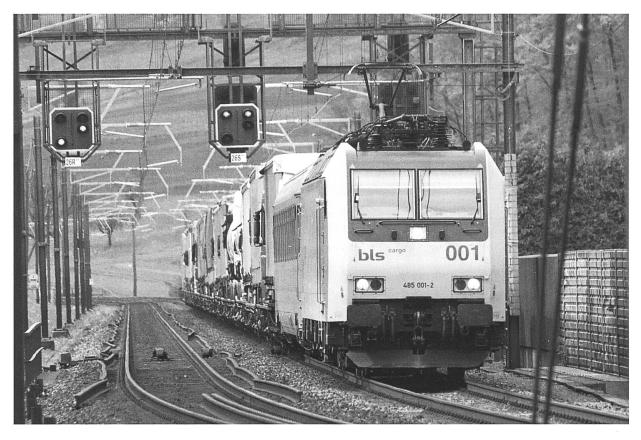
Abb. 4 Das Sonderprofil der Huckepackzüge (4 m Eckhöhe der Lastwagen) gegenüber dem üblichen Lichtraumprofil der Lokomotive und des Begleitwagens ist aus dieser Perspektive deutlich erkennbar. Der Zug ist auf der nördlichen, doppelspurig SIM-tauglichen Zulaufstrecke des LBT zwischen Basel und Olten bei Tecknau unterwegs (30. April 2012).
