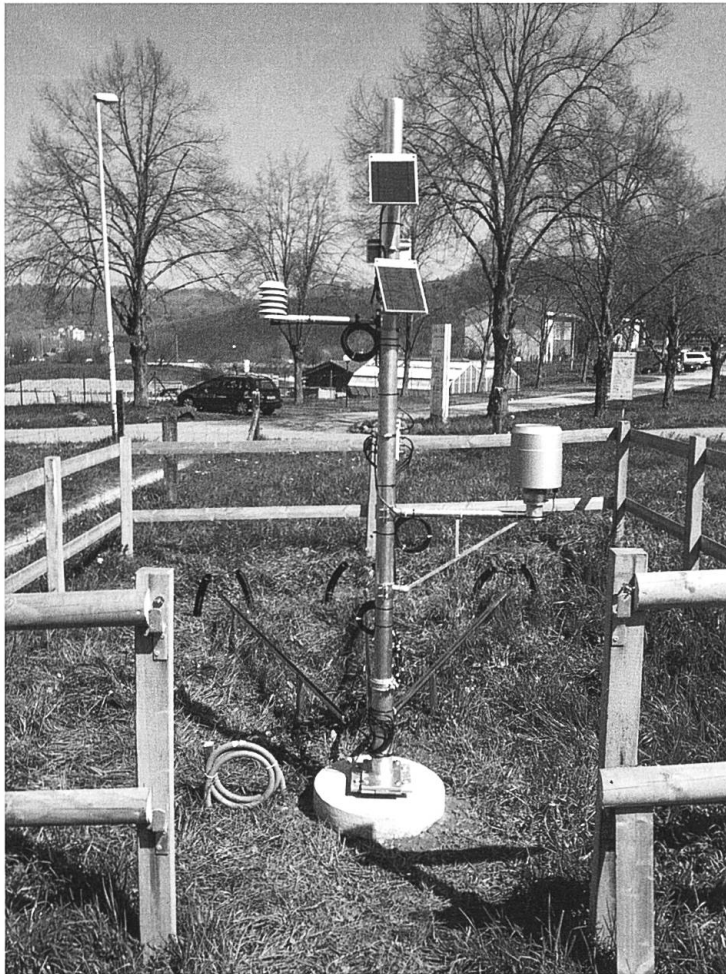
Abb. 1 Das Inventar einer Bodenmessstation am Beispiel der Station "Gränichen-Liebegg" im Kanton Aargau. In der eingezäunten Anlage befindet sich der Messmast mit dem Regensmesser (rechts) und dem Lufttemperatur- und Luftfeuchtigkeitsmessinstrument (links). Weiter sind zwei Solarpanels und die technische Apparatur zur Speicherung und Übermittlung der Daten am Mast befestigt. Vom Mast weg führen drei Arme zu den Standorten der T8 Tensiometer, deren Standorte durch die schwarzen Kabelabdeckungen an der Erdoberfläche angedeutet sind. Die graue Leitung links wäre für eine externe Stromzufuhr gedacht.
