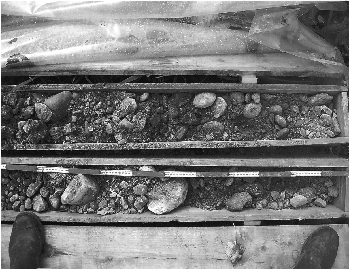
Abb. 6 Im November 2005 wurde mit Rotationskernbohrungen in Feld 1 der Wässerstelle Verbindungsweg (+W3) Material gewonnen. Die hellen und dunklen Balken auf der Massstabsleiste sind jeweils 10 cm lang. Das Material wurde für Perkolationsversuche in die Laborsäulenanlagen eingefüllt, nachdem Teilproben zur Analyse auf verschiedene Parameter entnommen worden waren. Foto: F.R. Storck
