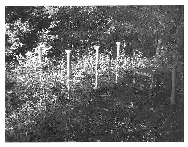
Abb. 4 Impression von der Wässerstelle Verbindungsweg (+W3) während einer Wässerungsphase von Feld 1 im Juli 2006. Die aus dem Wasser ragenden Rohre sind Grundwassermessstellen, der Tisch dient der Aufnahme von Messgeräten. Die Installationen wurden bereits in Vorgängerarbeiten u. a. von Rüetschi (2004) genutzt.
