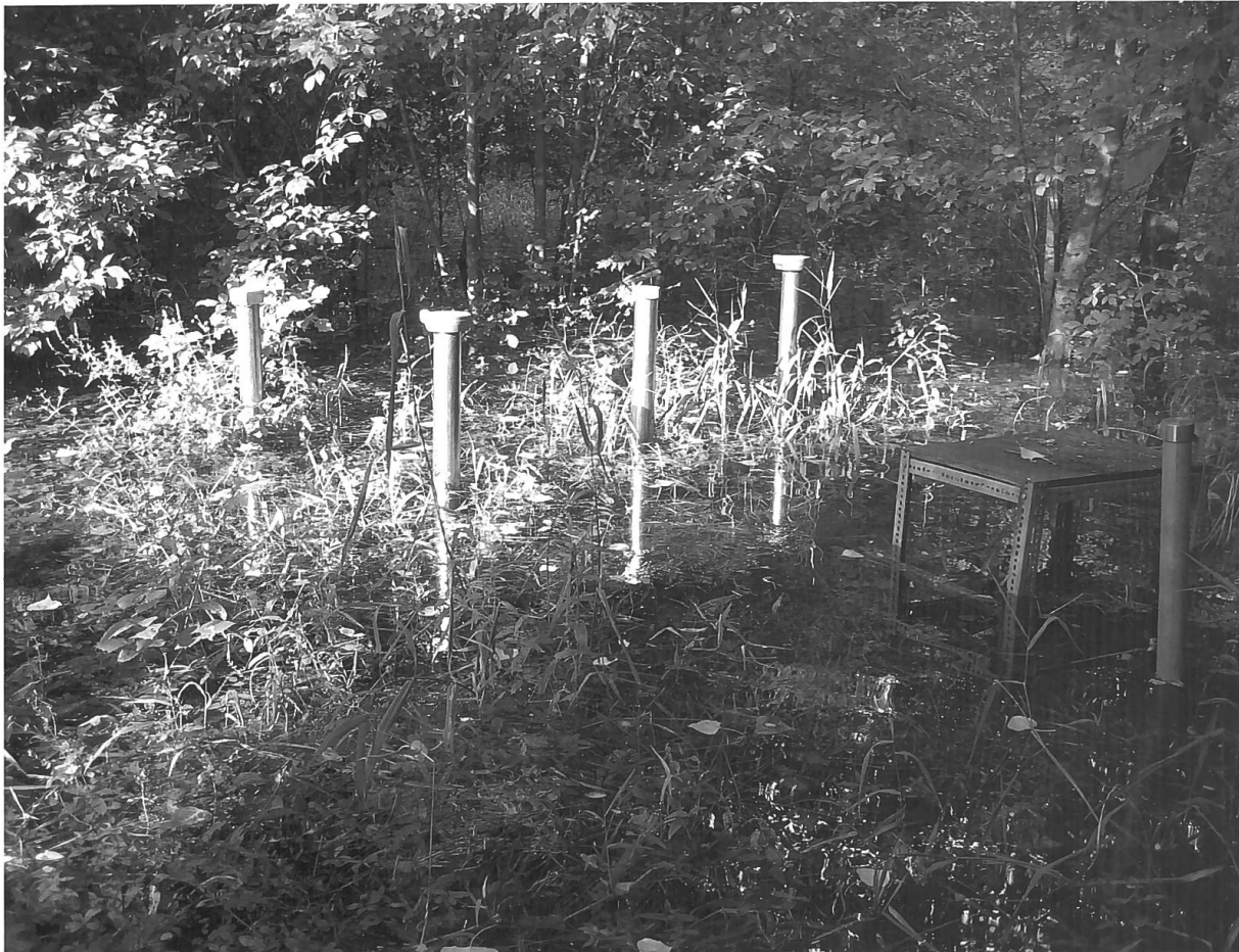
Abb. 4 Impression von der Wasserstelle Verbindungsweg (+W3) während einer Wässerungsphase von Feld 1 im Juli 2006. Die aus dem Wasser ragenden Rohre sind Grundwassermessstellen, der Tisch dient der Aufnahme von Messgeräten. Die Installationen wurden bereits in Vorgängerarbeiten u. a. von Rüetschi (2004) genutzt.
