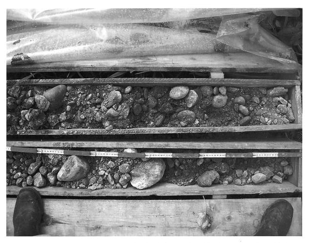
Abb. 6 Im November 2005 wurde mit Rotationskernbohrungen in Feld 1 der Wässerstelle Verbindungsweg (+W3) Material gewonnen. Die hellen und dunklen Balken auf der Massstabsleiste sind jeweils 10 cm lang. Das Material wurde für Perkolationsversuche in die Laborsäulenanlagen eingefüllt, nachdem Teilproben zur Analyse auf verschiedene Parameter entnommen worden waren.
