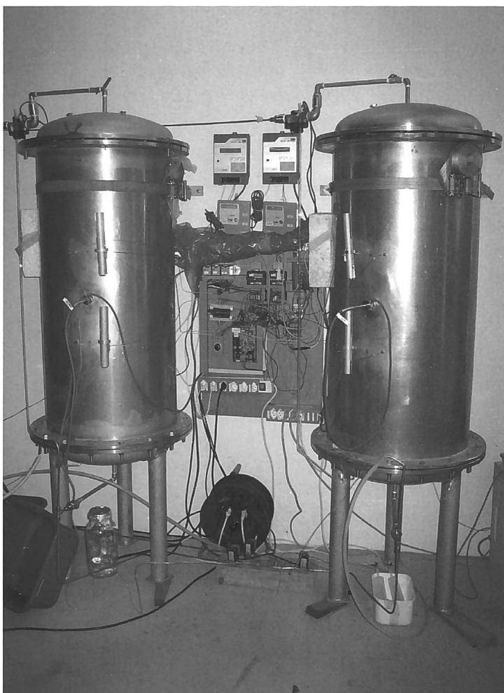
Abb. 5 Laborsäulenanlage aus Edelstahl (links und rechts, Höhe 1 m, Durchmesser 50 cm) mit Mess- und Regeltechnik (Bildmitte) zur automatisierten Gas- und Wasserprobenahme und zur Aufzeichnung verschiedener Parameter wie Temperatur, Durchfluss, CO_2 -Konzentration. Der Säulenkorpus wurde nach Plänen von F.R. Storck überwiegend von den Werkstätten der IWB gefertigt, die Steuer-, Mess- und Regelungseinheiten von F.R. Storck konzipiert, programmiert und zusammengesetzt. Standort der Säulenanlage war die Schnellfilteranlage der IWB im Süden der Langen Erlen.
