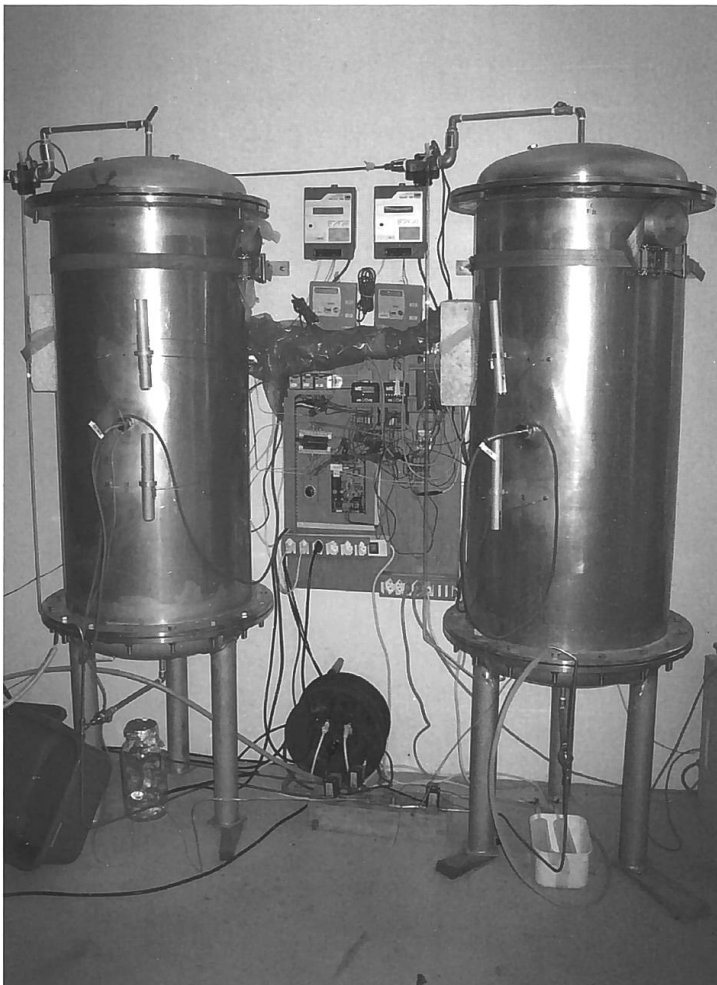
Abb. 5 Laborsäulenanlage aus Edelstahl (links und rechts, Höhe 1 m, Durchmesser 50 cm) mit Mess- und Regeltechnik (Bildmitte) zur automatisierten Gas- und Wasserprobenahme und zur Aufzeichnung verschiedener Parameter wie Temperatur, Durchfluss, \text{CO}_2 -Konzentration. Der Säulenkorpus wurde nach Plänen von F.R. Storck überwiegend von den Werkstätten der IWB gefertigt, die Steuer-, Mess- und Regelungseinheiten von F.R. Storck konzipiert, programmiert und zusammengesetzt. Standort der Säulenanlage war die Schnellfilteranlage der IWB im Süden der Langen Erlen.
