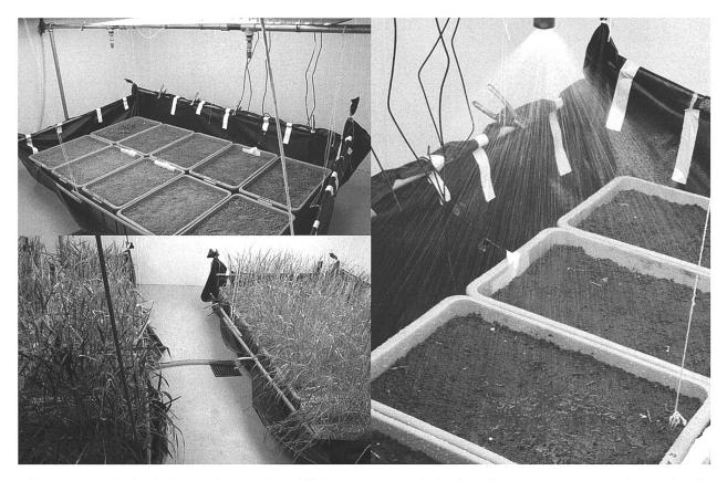
Abb. 1 Jeweils fünf Kisten eines Bodens bilden eine Versuchsfläche mit "extremem" oder "immerfeuchtem" Regenregime (links oben). Die Bewässerung erfolgt mittels Düsen, die Regenmenge wird über die Zeit gesteuert (rechts). Der Weizen auf der "immerfeuchten" linken, und der "extremen" rechten Versuchsfläche (Foto unten links).
