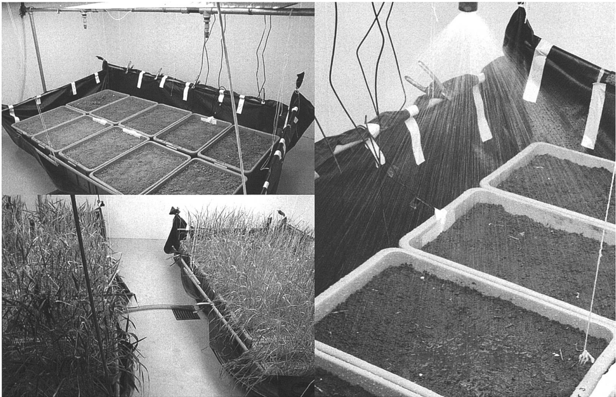
Abb. 1 Jeweils fünf Kisten eines Bodens bilden eine Versuchsfläche mit “extremem” oder “immerfeuchtem” Regenregime (links oben). Die Bewässerung erfolgt mittels Düsen, die Regenmenge wird über die Zeit gesteuert (rechts). Der Weizen auf der “immerfeuchten” linken, und der “extremen” rechten Versuchsfläche (Foto unten links). Fotos: Ruth Strunk 2011
