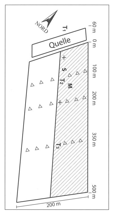
Abb. 3 Aufsicht des experimentellen Aufbaus. Die graue Fläche bezeichnet eine Grasfläche, die weisse Fläche ein mit Acrylbahnen bedecktes Kartoffelfeld. T<sub>1</sub> bis T<sub>3</sub> zeigen die Standorte der Messmasten, M den Standort der meteorologischen Station und S den Standort des SODAR-Systems an. Die + Symbole bezeichnen alleinstehende Burkard-Fallen, Dreiecke bezeichnen AOC-Pollenfallen.
