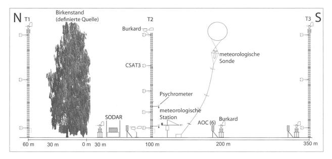
Abb. 2 Ansicht des experimentellen Aufbaus entlang der Talachse (NNW-SSE).
