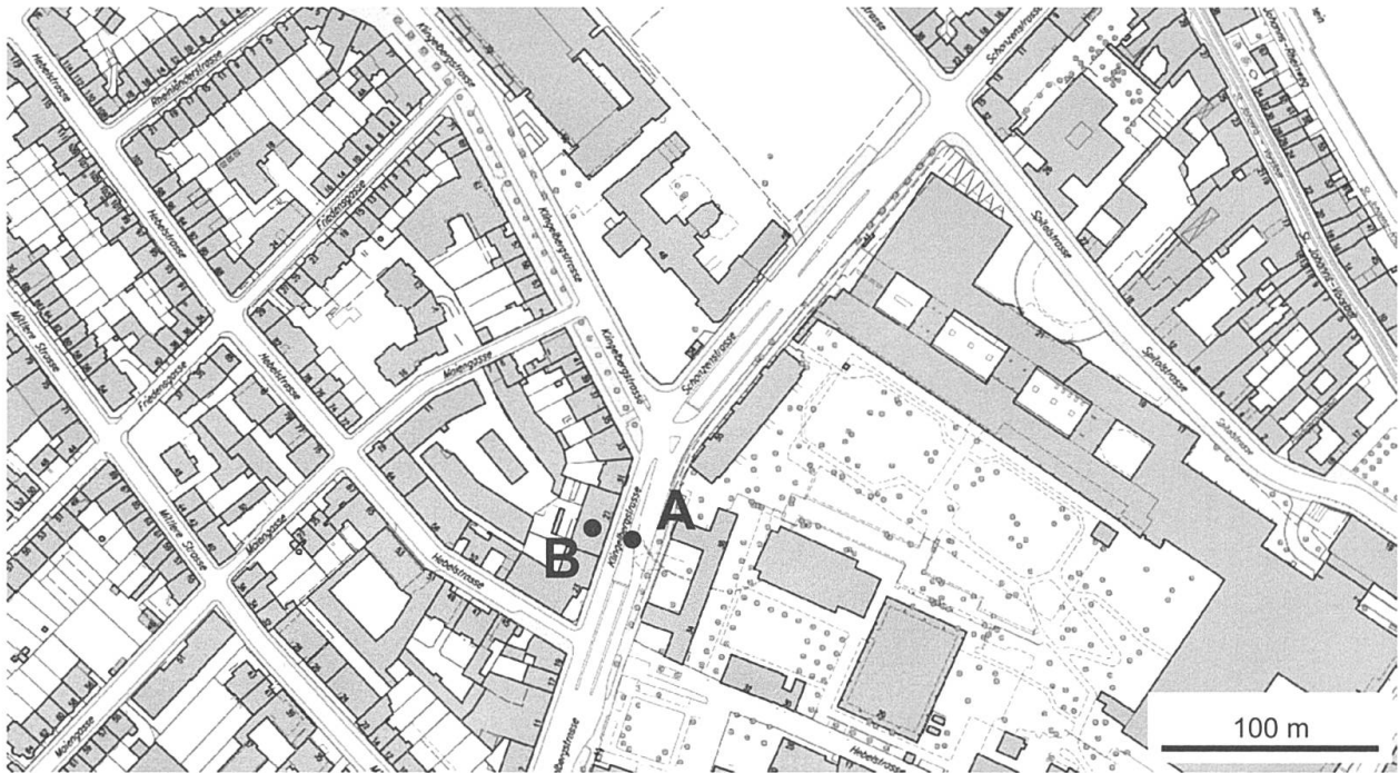
Abb. 1 Karte der Umgebung des Mess-Standes an der Klingelbergstrasse. A: 19 m Mast in der Strassenschlucht; B: 39 m Mast auf dem Dach des Instituts.
