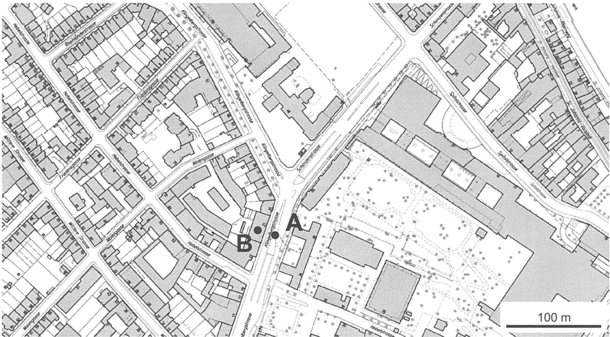
Abb. 1 Karte der Umgebung des Mess-Standortes an der Klingelbergstrasse. A: 19 m Mast in der Strassenschlucht; B: 39 m Mast auf dem Dach des Instituts.
