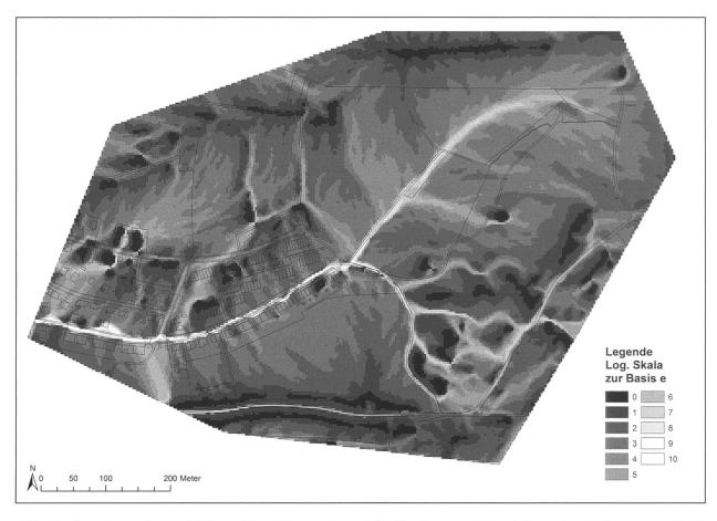
Abb. 5 3 m-Raster im Multiflow-Algorithmus dargestellt. Zur besseren Darstellung der Abflusswege (hell) wurde die Skala logarithmisiert, d. h. die eigentliche Zahl muss mit e exponiert werden (Universität Basel, Stand 06.12.2009; Benutzungsbewilligung des Grundbuch- und Vermessungsamtes Basel-Stadt zur Verwendung der CAD-Daten vom 01.04.2009; alle Rechte vorbehalten). *Autorin: Alexandra Wegmüller*
