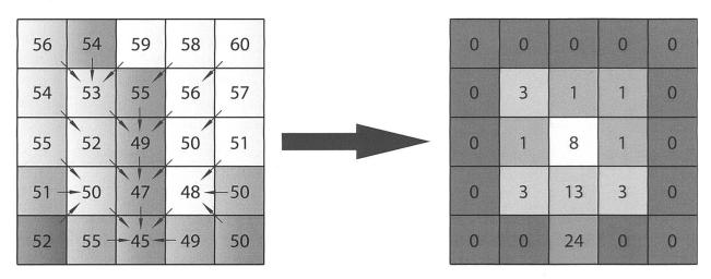
Abb. 3 Flow Accumulation beim Singleflow-Algorithmus (verändert nach  $\mathfrak{F}_2$ ).
