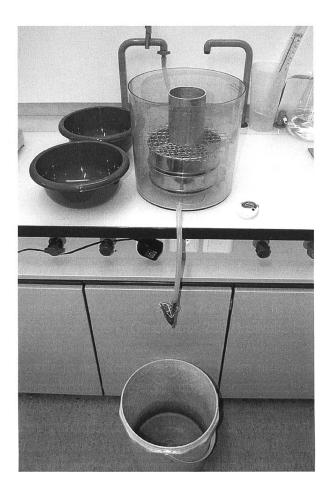
Abb. 2 Laboreinrichtung nach *Frei* (2006). In den metallenen Behältern auf dem Sieb wurden die Bodenproben sanft platziert und anschliessend mit Leitungswasser geflutet.
