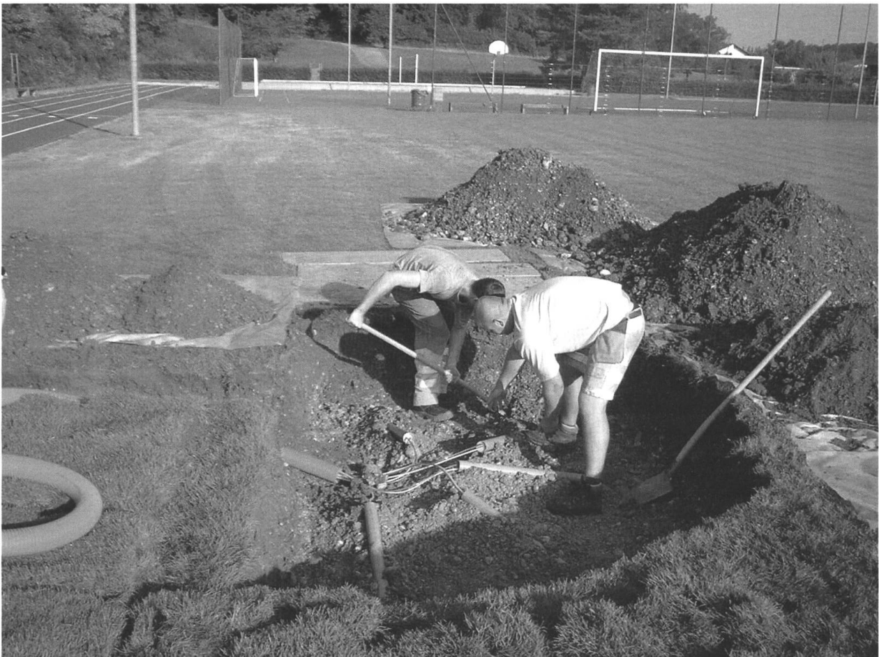
Abb. 4 Installation von Saugkerzen zur Bestimmung des Nitrataustrags über das Bodenwasser unter einem Sportplatz. Dieser Standort diente als Vergleich zu Acker- und Waldstandorten. Foto: C. Seiberth
