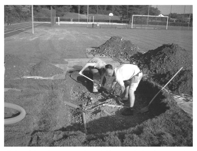
Abb. 4 Installation von Saugkerzen zur Bestimmung des Nitrataustrags über das Bodenwasser unter einem Sportplatz. Dieser Standort diente als Vergleich zu Acker- und Waldstandorten. Foto: C. Seiberth
