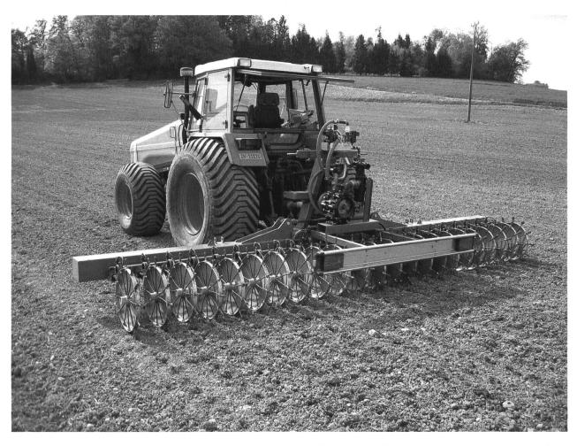
Abb. 2 Radinjektor für die Cultan-Düngung. Cultan steht für "Controlled Uptake Long Term Ammonium Nutrition" (sinngemäss: langfristig geregelte Ammoniumzufuhr). Die Stickstoff-Versorgung beruht dabei auf dem Anlegen eines Ammonium-Depots im Boden, d. h. es werden sehr hoch konzentrierte Flüssigdünger appliziert. Die sternförmig angeordneten Nippel am Injektionsrad sind verschlossen. Der Flüssigkeit tritt durch seitliche Öffnungen aus, wenn die Nippel in den Boden einstechen. Foto: U. Meier
