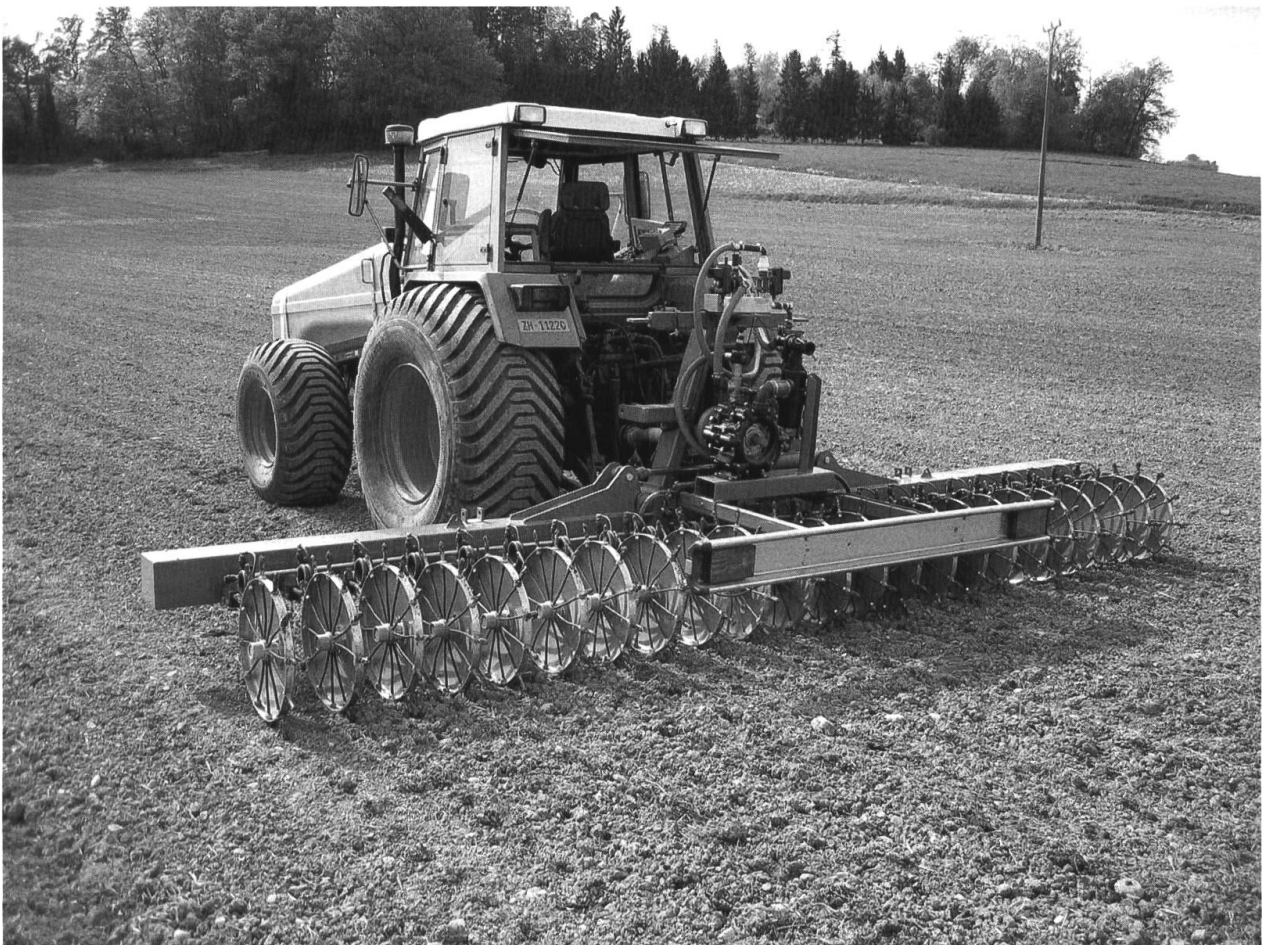
Abb. 2 Radinjektor für die Cultan-Düngung. Cultan steht für “Controlled Uptake Long Term Ammonium Nutrition” (sinngemäss: langfristig geregelte Ammoniumzufuhr). Die Stickstoff-Versorgung beruht dabei auf dem Anlegen eines Ammonium-Depots im Boden, d. h. es werden sehr hoch konzentrierte Flüssigdünger appliziert. Die sternförmig angeordneten Nippel am Injektionsrad sind verschlossen. Der Flüssigkeit tritt durch seitliche Öffnungen aus, wenn die Nippel in den Boden einstechen. Foto: U. Meier
