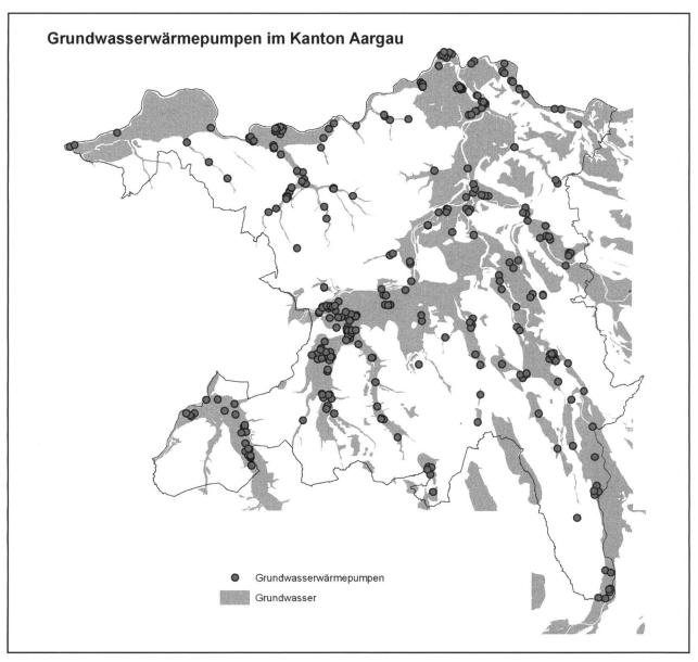
Abb. 5 Fast 400 Grundwasserwärmepumpen stehen heute im Aargau im Einsatz (*Egloff* 2007). Sie entziehen dem Grundwasser insgesamt rund 25'000 Kilowatt an Wärme, was dem Energieinhalt von 22'550 Kubikmeter Heizöl entspricht. Die grosse Nachfrage, weitere Anlagen zu installieren, kann lokal zu Nutzungskonflikten führen.
