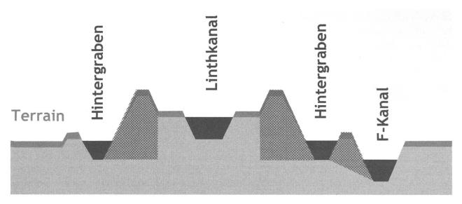
Abb. 3 Die drei hydrologischen Niveaus des unteren Linthkanals und der Entwässerungsgräben (*Jud* 2007, 50).
