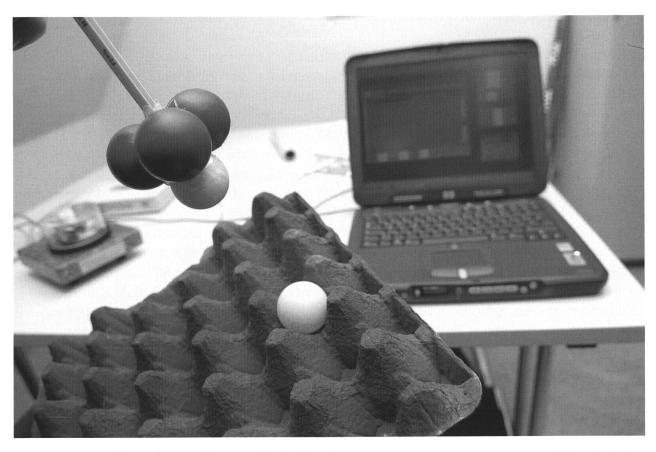
Abb. 2 Ein Modellaufbau für das Rasterkraftmikroskop.
