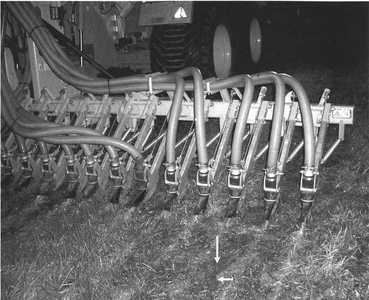
Abb. 2 Ausbringen des Markierstoffs Uranin mit Schleppverteiler bei Nacht am 25.05.2004.
