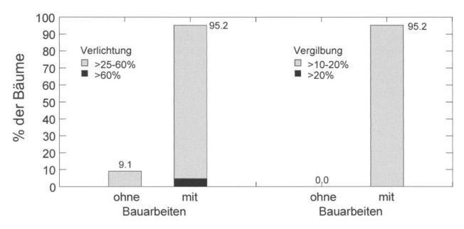
Abb. 12 Kronenverlichtung bei Platanen an der Grenzacherstrasse ohne und mit Tiefbauarbeiten im Wurzelbereich.
