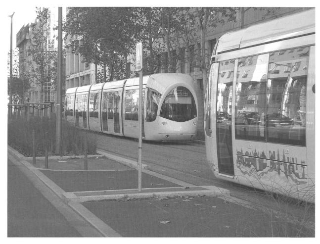
Abb. 5 Eigene Spuren machen den Trambetrieb wirtschaftlicher und sind bei modernen Tramsystemen Standard: Tramtrasse in Lyon, nahe des Bahnhofs Part-Dieu. *Photo: Alain Groff*
