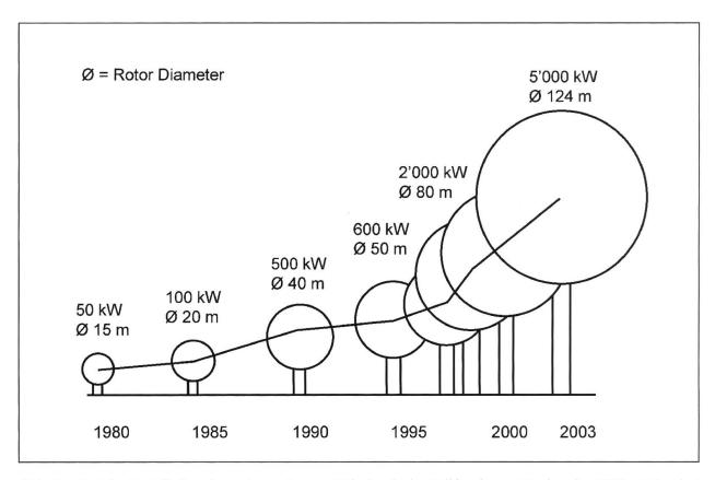
Abb. 1 Seit der Installation der ersten grösseren Windparks in Kalifornien zu Beginn der 1980er Jahre hat die technische Weiterentwicklung der Windturbinen zu immer grösseren Anlagen und somit zu tieferen Gestehungskosten geführt. Aufgrund der immensen Grösse und der damit zusammenhängenden grossen Herausforderungen an die Logistik, wird es in der Schweiz kaum Anlagen geben, welche grösser als 2'000 kW sind.
