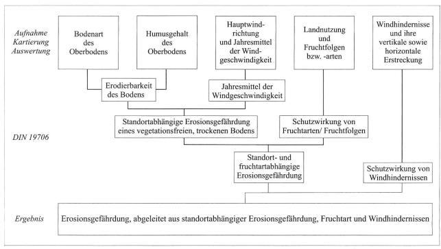
Abb. 3 Schema der DIN 19706 – Ermittlung der Erosionsgefährdung von Böden durch Wind.
