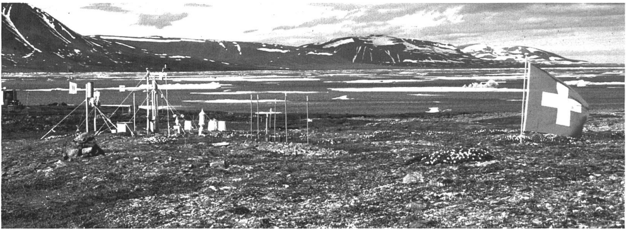
Abb. 2 Messeinrichtung (Tessera) zur Erfassung der relevanten Stoff- und Energieflüsse in der Landschaft, hier eingesetzt während der internationalen geowissenschaftlichen Spitzbergenexpedition (SPE 90–92) im Liefdefjord (Nord-Spitzbergen). Photo: C. Wüthrich
