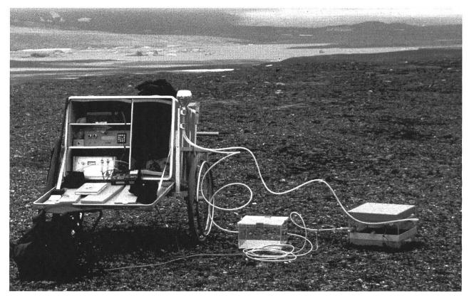
Abb. 4 Mobile Gaswechselanlage zur Messung des CO<sub>2</sub>-Gaswechsels von unterschiedlichen Tundratypen, hier im Einsatz in einem Einzugsgebiet der Eidembukta (Westküste Spitzbergens). *Photo: C. Wüthrich*
