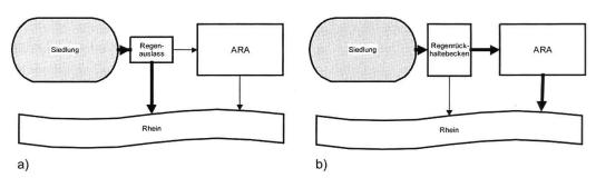
Abb. 3 Ableitung von Schmutz- und Regenwasser a) ohne und b) mit Regenrückhaltebecken
