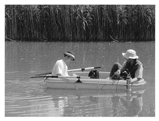
Abb. 2 Die Profilmessungen im Quellsee für die Erfassung der täglichen und jahreszeitlichen Änderungen in der Wassersäule erfolgen teilweise mit einem Boot. Zu sehen ist die dazu verwendete YSI-Sonde (8.7.2003).
