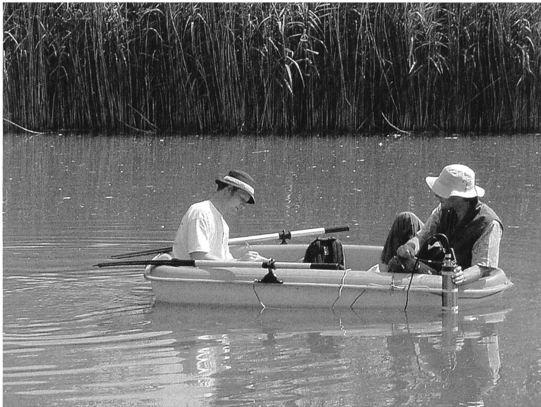
Abb. 2 Die Profilmessungen im Quellsee für die Erfassung der täglichen und jahreszeitlichen Änderungen in der Wassersäule erfolgen teilweise mit einem Boot. Zu sehen ist die dazu verwendete YSI-Sonde (8.7.2003). Photo: T. Vögtli
