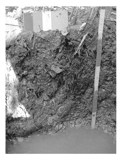
Abb. 4 Grube im Substrat des Pflanzenklärgebietes im oberen Becken. In den obersten 10 cm sind die aus dem Birswasser abgesetzten Sedimente zu erkennen. (Aufnahme Oktober 2003)
