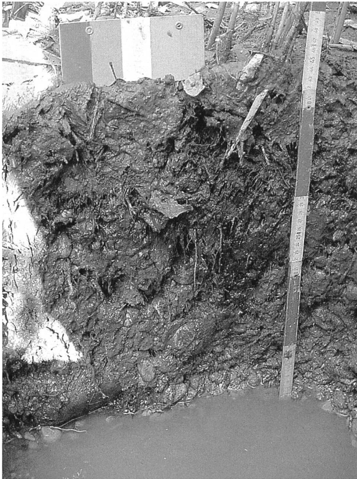
Abb. 4 Grube im Substrat des Pflanzenklärgbietes im oberen Becken. In den obersten 10 cm sind die aus dem Birswasser abgesetzten Sedimente zu erkennen. (Aufnahme Oktober 2003)
