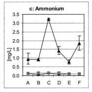
Abb. 6 Nitrat- und Ammoniumkonzentrationen sowie Sauerstoffsättigung (Mittelwerte mit min./max.) in Fliessrichtung. Die zu weiten Teilen parallel verlaufenden Fliesskurven zeigen die Niveauunterschiede deutlich auf.
