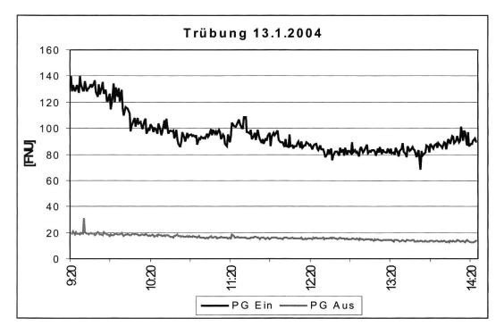
Abb. 7 Während des Experimentes "Trübungswelle" wurde vor (PG Ein) und nach (PG Aus) der Passage durch das Pflanzenklärgebiet die Trübung mittels zweier YSI-Sonden permanent aufgezeichnet. Der Reinigungseffekt bezüglich der mitgeführten Schwebstofffracht ist offensichtlich.
