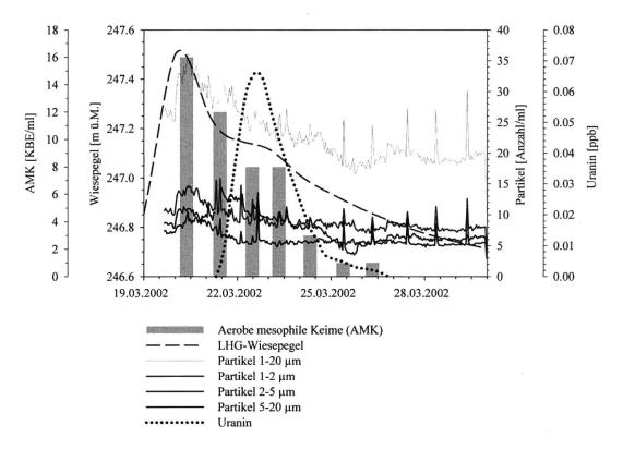
Abb. 6 Vergleich der Partikelanalyse mit der Uranin-Durchbruchskurve in Brunnen 3 vom 19. bis 30.03.2002; LHG: Landeshydrologie.
