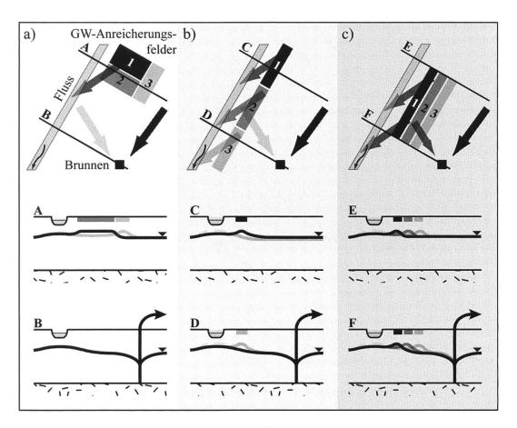
Abb. 7 Hydraulische Massnahmen und Auswirkungen auf die Fluss-Grundwasser Interaktion: a) Ist-Zustand; b) Anreicherungsfelder parallel zum Fliessgewässer; c) Anreicherungsfelder senkrecht zum Fliessgewässer; Nummern der Anreicherungsfelder dokumentieren abwechselnde Zeitperioden des Betriebs der Anreicherungsfelder.
