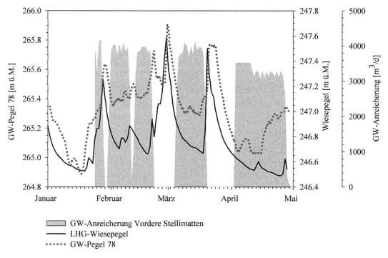
Abb. 3 Wasserstand der Wiese und in Piezometer 78 sowie Grundwasser-Anreicherung in den Vorderen Stellimatten von Januar bis Mai 2002.
