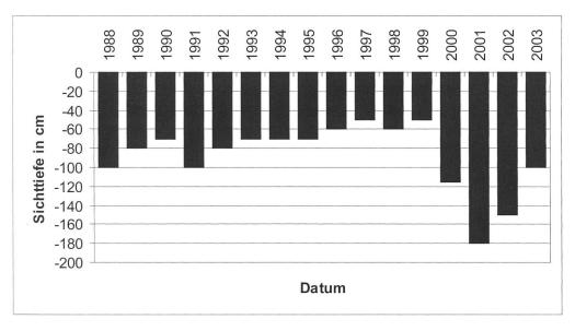
Abb. 6 Sichttiefe im Bergsee jeweils im Juni/Juli für den Zeitraum 1988–2003. Von 1987 bis 1999 lief die Tiefenwasserbelüftung nahezu ganzjährig. Seit dem Jahr 2000 wurden die Nährstoffeinträge durch den Zufluss um rund 40 % reduziert und der Betrieb der Tiefenwasserbelüftung wurde schrittweise auf 5 Monate pro Jahr reduziert.
