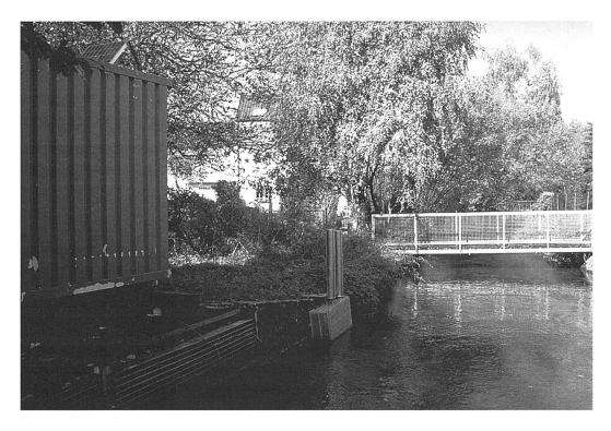
Abb. 3 Mühlenteich mit den beiden Sensoren des "Eingangswächters" (Bildmitte) und dem Container, in dem sich die Steuerelektronik und die Datenfernübertragung befindet.
