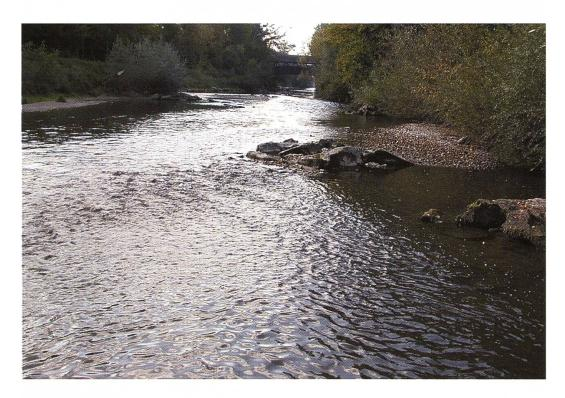
Revitalisierte Strecke der Birs in Münchenstein. Die Buhnen, die aus den Blöcken der früheren Uferverbauung errichtet wurden, lenken die Strömung ab und lassen rasch strömende Bereiche ("riffles") entstehen. Bei Elektroabfischungen konnten auf dieser Strecke grössere Bestände des Strömers (*Leuciscus souffia*) gefunden werden.
