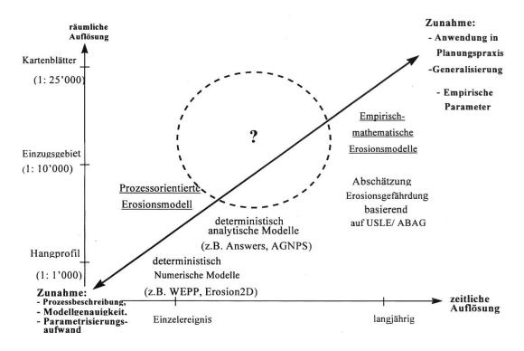
Abb. 1 Anwendungs- und Geltungsbereiche bestehender Erosionsmodelle.
