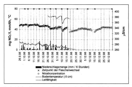
Abb. 3 Niederschlagssummen der letzten sechs Stunden und Bodentemperaturen (REKLIP-Station 'Breitenmatt', Gempen), Zeitpunkte der Flaschenwechsel, Nitratkonzentrationen und Leitfähigkeit des Quellwassers der 'südlichen' Schomelquelle.
