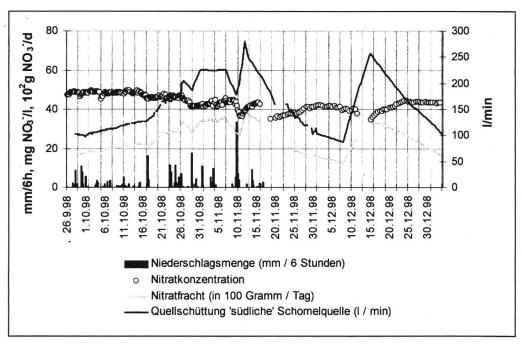
Abb. 4 Niederschlagssummen der letzten sechs Stunden (REKLIP-Station 'Breitenmatt', Gempen), Nitratkonzentrationen, Nitratfracht und Quellschüttung der 'südlichen' Schomelquelle.
