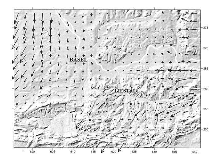
thermisch induzierten Luftströmungen – insbesondere die Bergwinde – nachgebildet und damit modellmässig auf alle Standorte in ähnlicher orographischer und topographischer Lage übertragen werden können.
