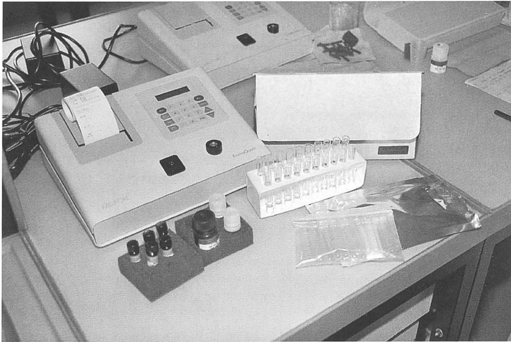
Abb. 1 EnviroGard Triazine QuantiTube Testkit und EnviroQuant Photometer. Zur Durchführung des ELISA-Tests wurden zusätzlich lediglich Pipetten, eine Stoppuhr, destilliertes Wasser und Fliesspapier benötigt (07.08.1996).
