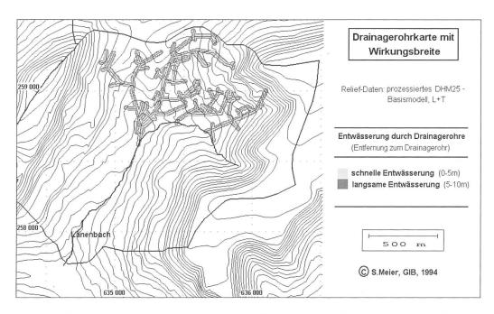
Abb. 4 Verlauf der Drainagerohre und deren Wirkung auf die Entwässerung des Bodens.
