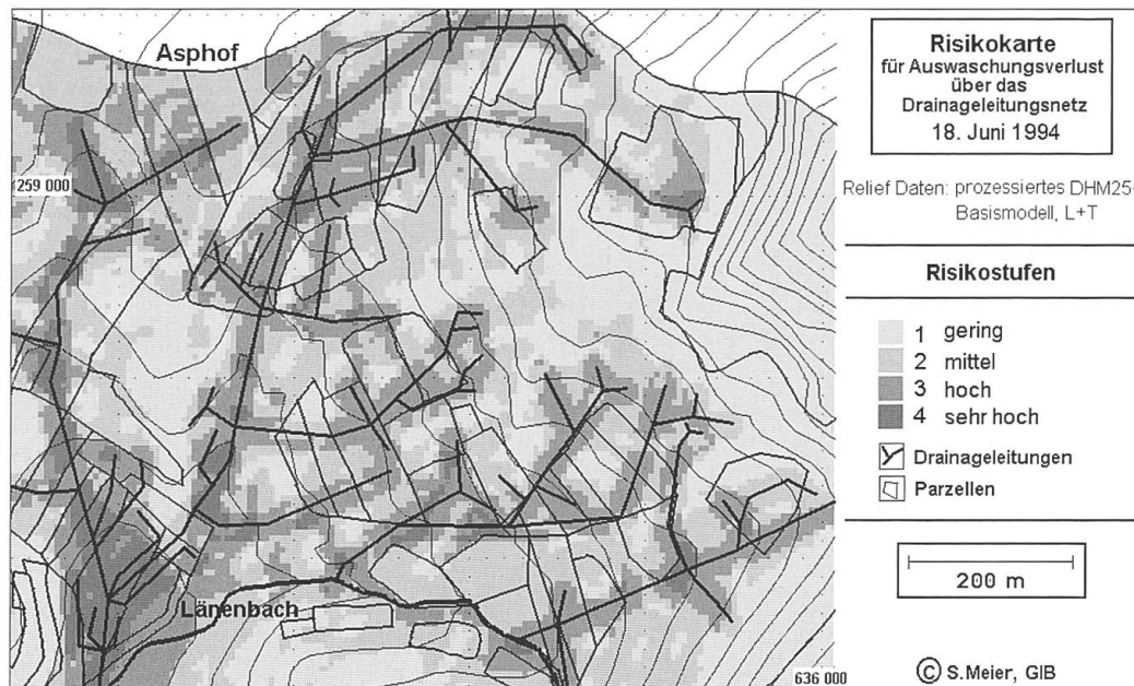
Abb. 7 Risikokarte für Auswaschungsverlust über das Drainageleitungsnetz am 18. Juni 1994.
