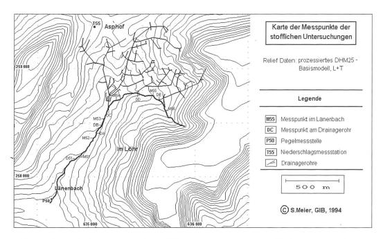
Abb. 2 Karte der Messpunkte der stofflichen- und wasserhaushaltlichen Untersuchungen im Länenbachgebiet und des Drainageleitungsnetzes.
