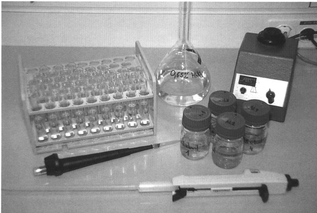
Abb. 1 Eluate der Bodenaufschlüsse verdünnt mit Salpetersäure.
