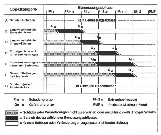
Abb. 6 Beispiel für die Differenzierung der Schutzziele im Kanton Uri. Der Bemessungsabfluss ist entsprechend der Objektkategorie zu wählen.
