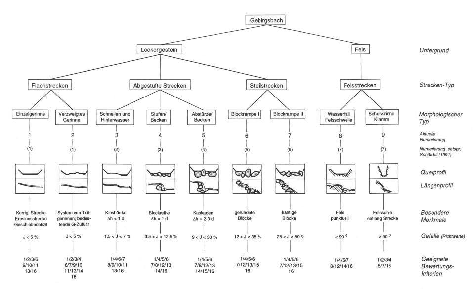
Abbildung 2 Morphologische Klassifikation von Gebirgsbächen mit Quer- und Längenprofil, besonderen Merkmalen, dem beobachteten Gefällsbereich (abweichende Gefälle sind denkbar) sowie den Nummern der Bewertungskriterien gemäss Tabelle 1, die zur Festlegung eines morphologisch verträglichen Restwasserabflusses geeignet sind (G: Geschiebe, d = Blockdurchmesser, Δh = Höhendifferenz einer Abtreppung, J = Gefälle).
