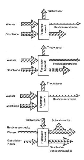
Abb. 3 Schematische Darstellung von vier Eingriffen, die sich unterschiedlich auf die Morphologie eines Gebirgsbaches auswirken.
