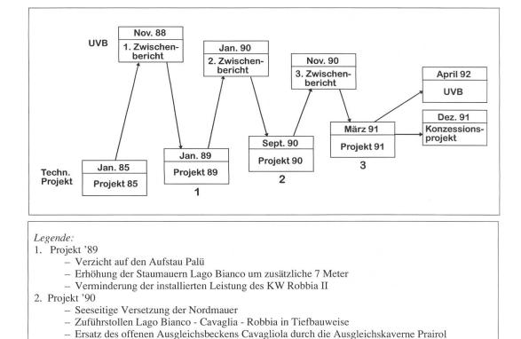
Abb. 3 Prozess-UVP für den Ausbau der Kraftwerkstufen im oberen Puschlav.
