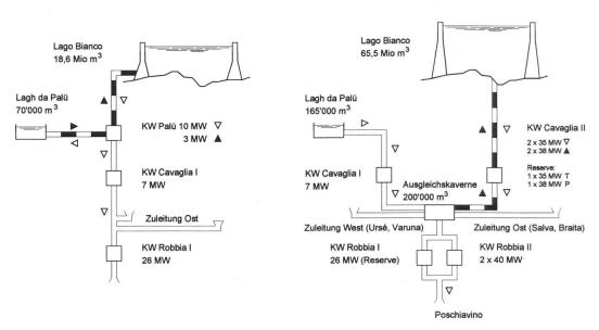
Abb. 1 Ausbau der Kraftwerkstufen im oberen Puschlav.
